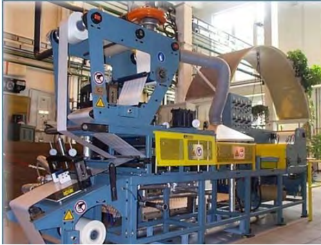
Schéma 64: Gauche: Une machine de préimprégnation construite par le Composite Materials Group pour la production de matériaux préimprégnés employant des fibres et des résines. (Katholieke Universiteit Louvain) droite: Une machine ajoutant la résine à sept lignes de stratifié (Hunting Engineering, Ltd.)
