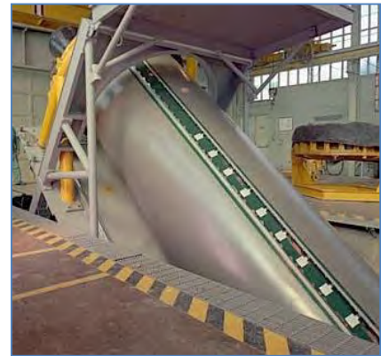
Schéma 49: Le propergol solide sous forme liquide est versé dans des enveloppes de fusée et coulé dans la forme requise. La coulée est déplacée par un support hydraulique pour éliminer les bulles ou autres défauts. (ATK)
