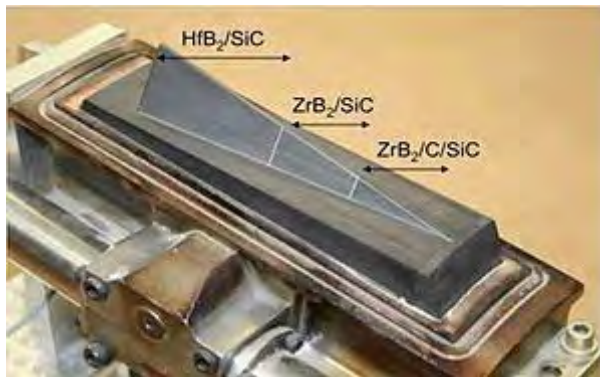
Schéma 73: Un strake UHTC composé de trois sections différentes avec des compositions UHTC différentes
