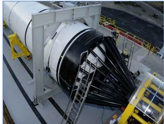
Schéma 139: Le système de mesure de charge sur la station d'essai d'un moteur à propergol solide (ATK)
