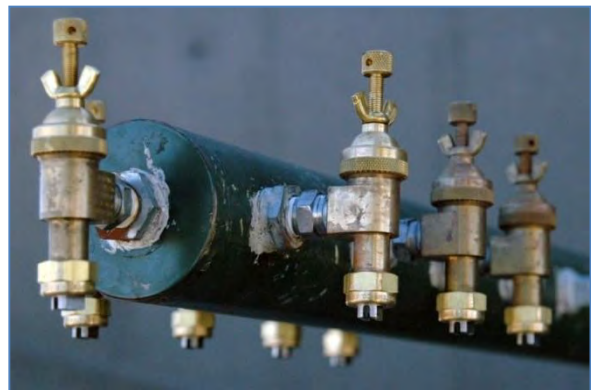
Schéma 165: Un système de jet aérien modulaire, utilisé pour l'application de pesticide, peut employer un arrangement appelé volume très réduit et des tuyères de perche de jet spécialisés comme ceux montrés ici pour diffuser une demi-once à une once de produit chimique sur une surface d'un acre. (l'Armée de l'air des États-Unis)
