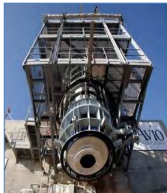
Schéma 140: Un moteur-fusée à propergol solide sur une station d'essai. (Avio SpA)
