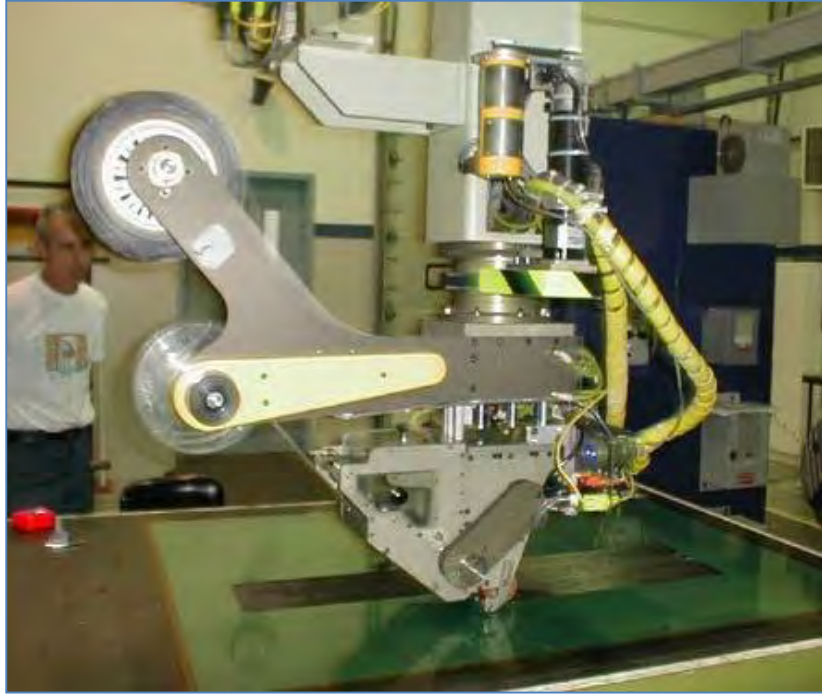
Schéma 62: Une tête de machine de pose de ruban automatisée. (Dynamique automatisée)
