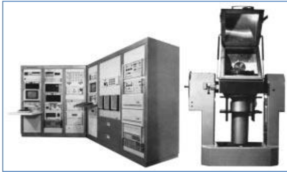
Schéma 94: Une station de test de gyroscope biaxial utilisant un simulateur de mouvement/table de variations (Contraves, Inc)
