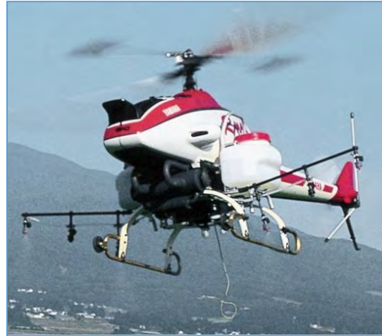
Schéma 166: Un UAV à voilure tournante conçu avec des réservoirs de produits chimiques et des rampes de pulvérisation pour l'agriculture. (Yamaha)
