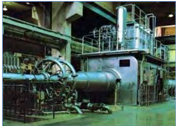
Schéma 136: Une soufflerie hypersonique capable d'atteindre Mach 5 pour tester les conditions en vol pour des lanceurs (Mitsubishi Heavy Industries, Ltd)
