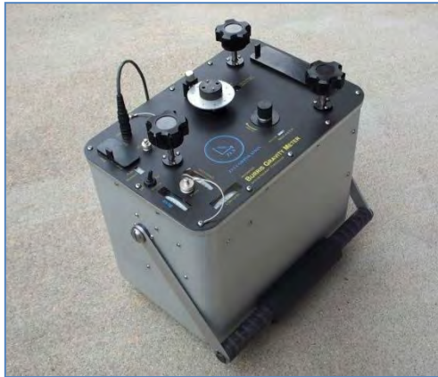
Schéma 115: Ce gravimètre automatisé est l'un des plus précis, robustes et légers. Dans des conditions normales, il peut être mis à niveau pour des mesures mgal dans les 30 secondes, et a un taux de dérive de moins de 0,5 mgal par mois à maturité (ZLS Corporation)
