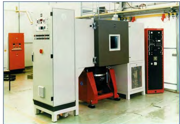
Schéma 144: Chambre à environnement contrôlé avec capacité de vibration (RMS Dynamic Test Systems)
