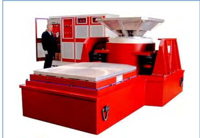
Schéma 135: Un exemple d'un propulseur avec table à glissement. (Kingdom Pty Ltd)
