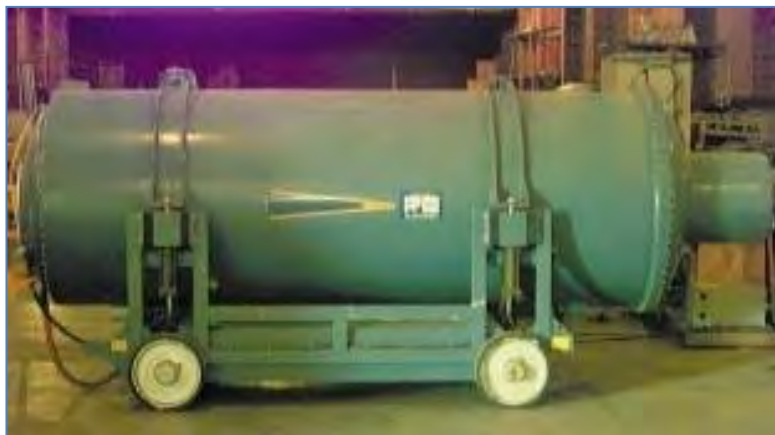
Schéma 146: Une unité de radiographie éclair de 2,3MeV utilisée pour inspecter des moteurs-fusées solides (Équipement de MTCR, manuel d'annexe de logiciel et de technologie, troisième édition (mai 2005))
