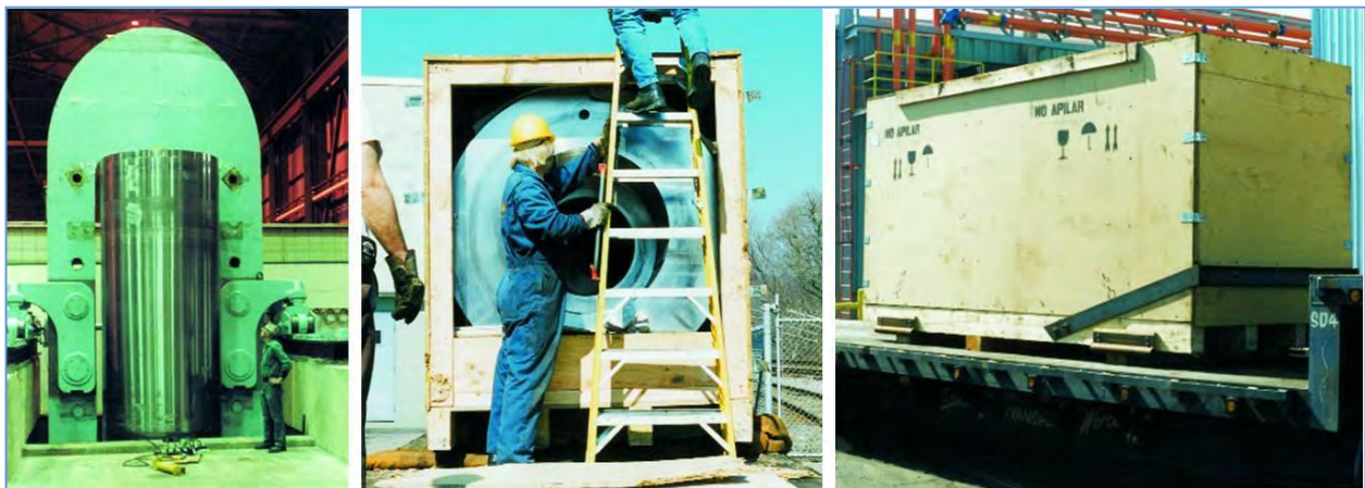
Schéma 66: Gauche : Vue de côté d'une grande presse isostatique. (Engineered Pressure Systems, Inc.) Centre et droite : Deux vues différentes d'une caisse d'expédition alternative pour une presse isostatique. (Engineered Pressure Systems, Inc.)
