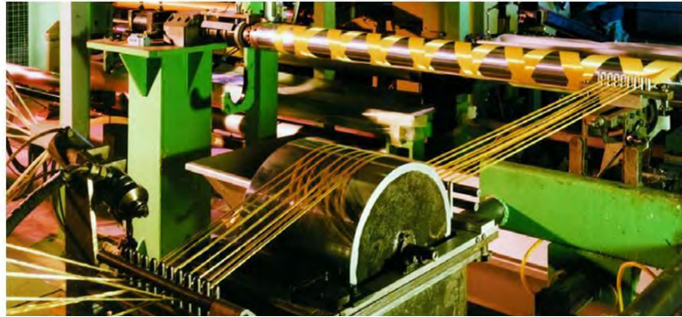
Schéma 64: Gauche: Une machine de préimprégnation construite par le Composite Materials Group pour la production de matériaux préimprégnés employant des fibres et des résines. (Katholieke Universiteit Louvain) droite: Une machine ajoutant la résine à sept lignes de stratifié (Hunting Engineering, Ltd.)
