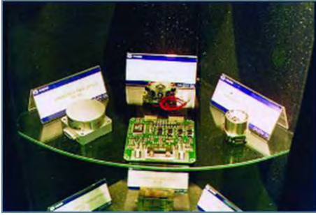
Schéma 83: Un FOG (à gauche), un RLG (au centre), et un accéléromètre (à droite). (Équipement de MTCR, manuel d'annexe de logiciel et de technologie, troisième édition (mai 2005))
