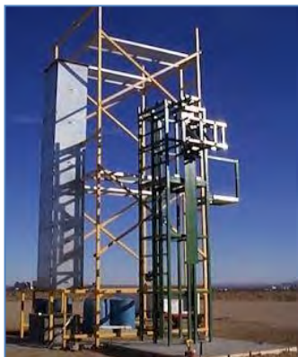
Schéma 141: Une station d'essai verticale conçue pour les moteurs-fusée à propulsion liquide. (Systèmes interorbitaux)
