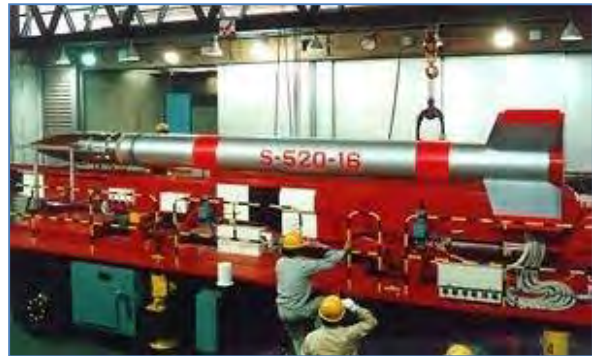
Schéma 162: Une grande fusée-sonde de catégorie II, capable de livrer une charge utile de 250 kilogrammes à une portée de 400 kilomètres. Le moteur à propergol solide de la fusée, avec le manteau de bec en acier, est entouré de quatre ailerons de queue en nid d'abeilles avec des bords d'attaque en alliage de titane. (JAXA)
