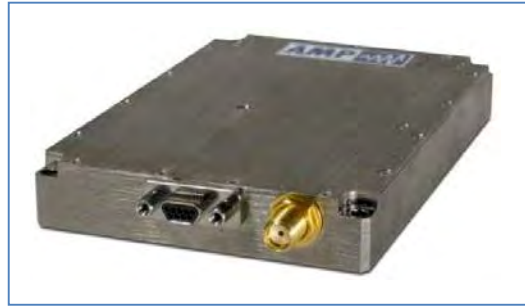
Schéma 117: Quelques émetteurs de télémessure sont conçus pour résister à des environnements rudes exigeant un boîtier compact et robuste (AMP)
