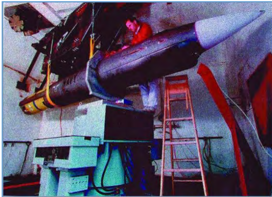
Schéma 133: Un pot vibrant étant préparé pour un essai de vibration sur un missile. (Unholtz-Dickie)
