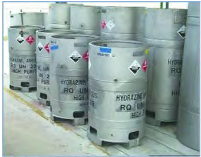
Schéma 57: Containers d'expédition de 34 gallons pour l'hydrazine anhydre en acier inoxydable de série 300. (Équipement de MTCR, manuel d'annexe de logiciel et de technologie, troisième édition (mai 2005))
