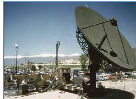
Schéma 119: Une grande antenne militaire SATCOM conçue pour des postes de grand commandement et postes de commandement mobiles et convenant aux communications avec les véhicules aériens sans pilote. (General Dynamics)
