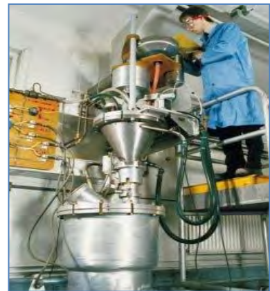
Schéma 51: Équipement de mélange de bouillie à double-base pour un petit moteur. (British Aerospace Limited)
