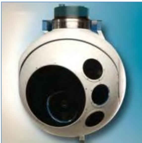
Schéma 100: Un capteur imageur passif est un système infrarouge à rendement élevé pour UAV qui peut admettre jusqu'à six sondes (Northrop Grumman)
