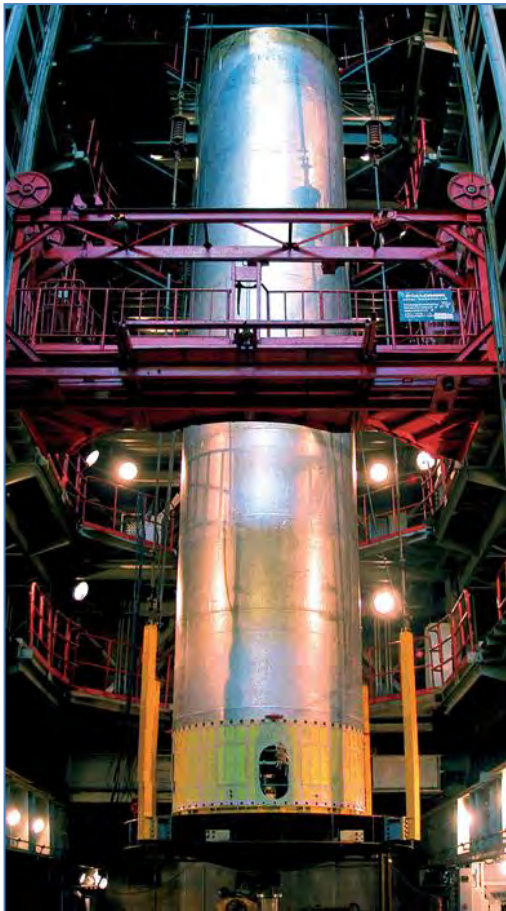
Schéma 134: Un premier étage de propulseur dans un banc d'essai de vibration (Krunichev Space Center)
