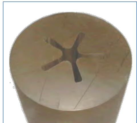
Schéma 56: Un échantillon de propergol à double base de moteur fusée. (Bayern-Chemie GmbH)
