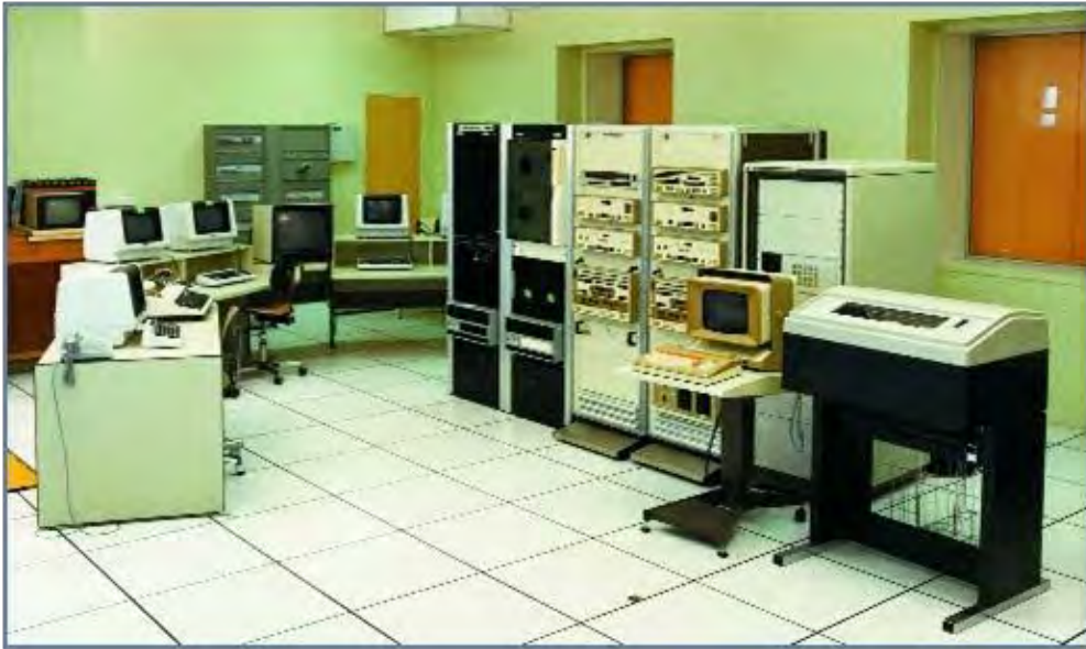
Schéma 121: Équipements de réception et de traitement des télémessures au sol représentatif. (In-Snec)
