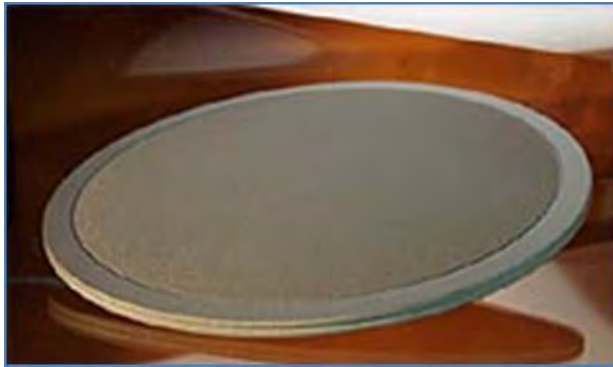
Schéma 72: Les enduits de carbure de silicium ont une vaste gamme d'applications spatiales et aérospatiales, y compris la protection du matériel en graphite de l'oxydation. (Schunk Group)
