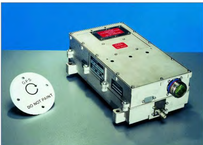
Schéma 102: Gauche: une unité de récepteur/processeur de système de localisation par satellite avec son antenne à plaque. (Aéro-électronique au sextant) Droite: une unité de récepteur/processeur de système de localisation mondial (Litton Guidance and Control Systems)
