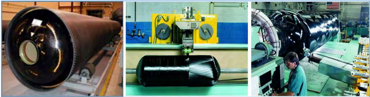
Schéma 61: Gauche: Une enveloppe de graphite époxyde produite à l'aide d'une machine d'enroulement de filaments avancée. (ATK) Centre: Machine de table d'enroulement de filaments (Thiokol Corp.) Droite: Une machine d'enroulement de filaments avec de multiples bobines de fibre. (Ibid)
