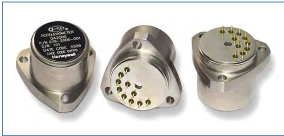
Schéma 77: Cet accéléromètre est utilisé dans de nombreux systèmes de navigation inertielle à strapdown commerciaux et militaires (Honeywell)
