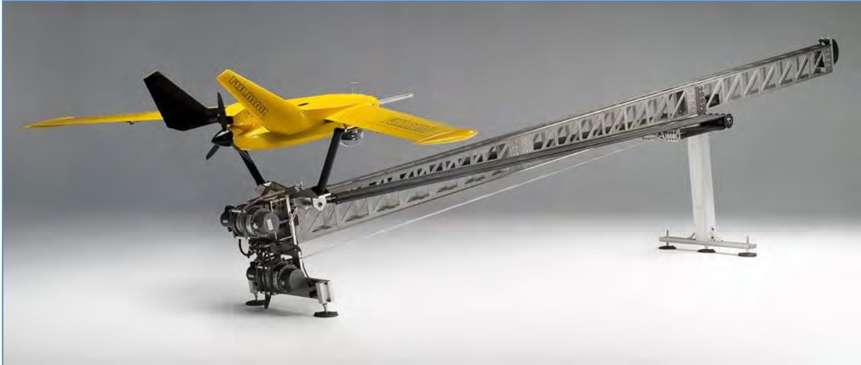
Schéma 164: Un UAV à résistance de moyenne portée. En dépit de sa petite taille, cet UAV élastique lancé par catapulte est capable de porter une charge utile d'1 kilogramme (caméras IR et numérique) à une portée de 400 kilomètres (Aerovision Vehiculos Aereos, SL)
