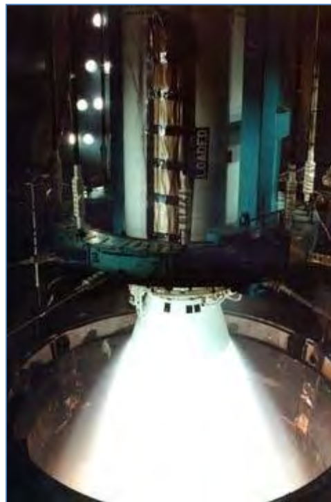
Schéma 142: Un moteur-fusée à propergol solide de taille réelle en test à haute altitude simulée (AEDC)
