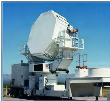
Schéma 124: Un radar mobile de poursuite de missile à réseau piloté en phase (Équipement de MTCR, manuel d'annexe de logiciel et de technologie, troisième édition (mai 2005))
