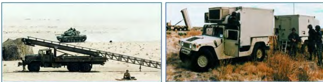
Schéma 114: Un lanceur pneumatique de véhicules aériens sans pilote Droite: Véhicules de commande et contrôle pour le lancement de missiles depuis des endroits fixes ou mobiles. (Équipement de MTCR, manuel d'annexe de logiciel et de technologie, troisième édition (mai 2005))
