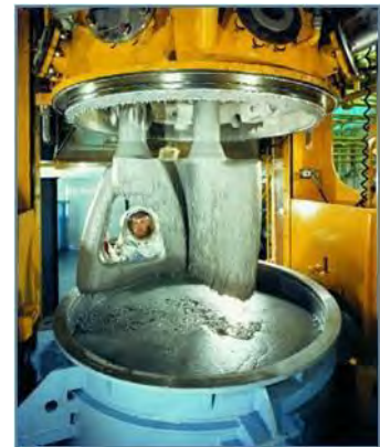
Schéma 53: Propergol solide mélangé dans un mélangeur planétaire vertical de 600 gallons. (Thiokol Corp.)
