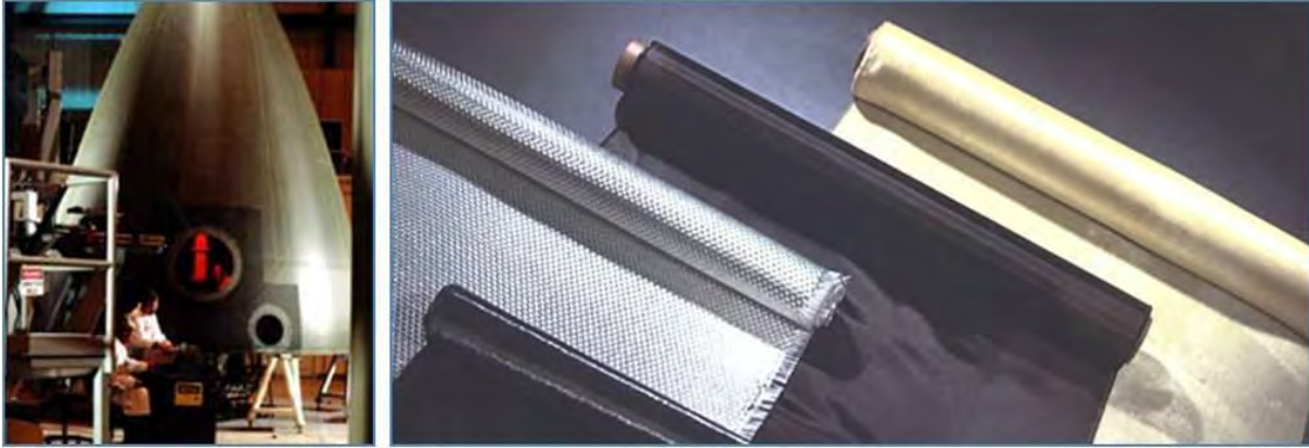
Schéma 68: Gauche: Une ogive pour un lanceur spatial fabriquée en employant des techniques de préimprégné avancées. (ATK) Droite: Matériau de préimprégné employé dans la fabrication de structures aérospatiales et de structures de défense composites de poids léger. (Ibid)
