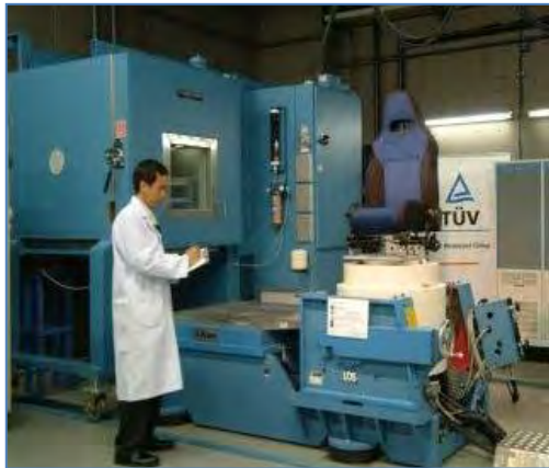
Schéma 143: Une configuration d'appareillage d'essai de vibration et environnementale. (TUV Rheinland)
