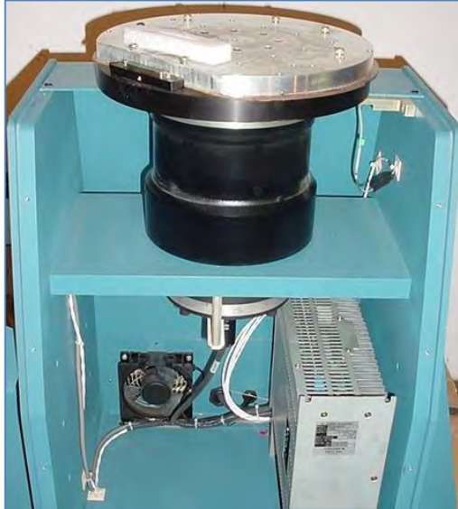
Schéma 93: Une table d'évaluation classique utilisée pour accorder des gyroscopes (Ideal Aerosmith, Inc)
