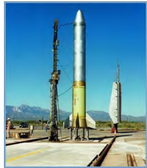
Schéma 108: Plateforme de lancement minimale avec portique et connexions à un système de fusée complet. (Équipement de MTCR, manuel d'annexe de logiciel et de technologie, troisième édition (mai 2005))
