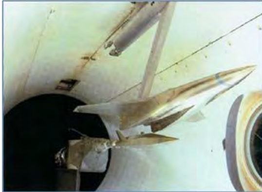
Schéma 138: Objets d'essai dans la section d'essai d'une soufflerie hypersonique (Équipement de MTCR, manuel d'annexe de logiciel et de technologie, troisième édition (mai 2005))
