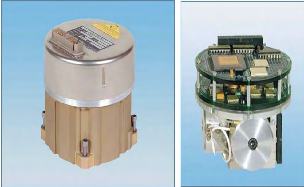
Schéma 87: Une centrale inertielle utilise les FOG et les accéléromètres micro-usinés. Elle est employée dans la stabilisation de l'espace, le guidage de missiles, les guidages de véhicules sans pilote et la commande de vol. (Northrop Grumman)
