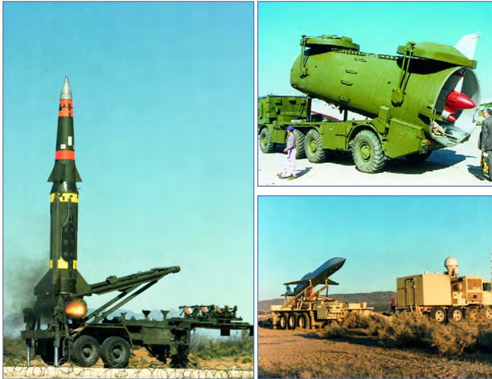
Schéma 113: un érecteur-lanceur détaché de son appareil moteur. Annexe sur les équipements, le logiciel et la technologie du MTCR Manuel, Troisième édition (Mai 2005)). Droite supérieure: un transporteur-érecteur-lanceur pour grand missile de croisière de catégorie II (Équipement de MTCR, logiciel et manuel de technologie, troisième édition (mai 2005)) Droite inférieure: L'érecteur-lanceur pour un véhicule aérien sans pilote assisté par fusée et son fourgon de commande et contrôle. (Teledyne Ryan Aeronautical)
