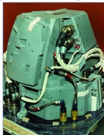
Рис. 1: Основная часть объединенной системы бортовых приборов крылатой ракеты. (Руководство Litton и системы управления)
