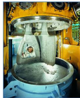
Рисунок 5. Твердое топливо, смешиваемое в 600-галлонном вертикальном планетарном смесителе. (Thiokol Corp.)
