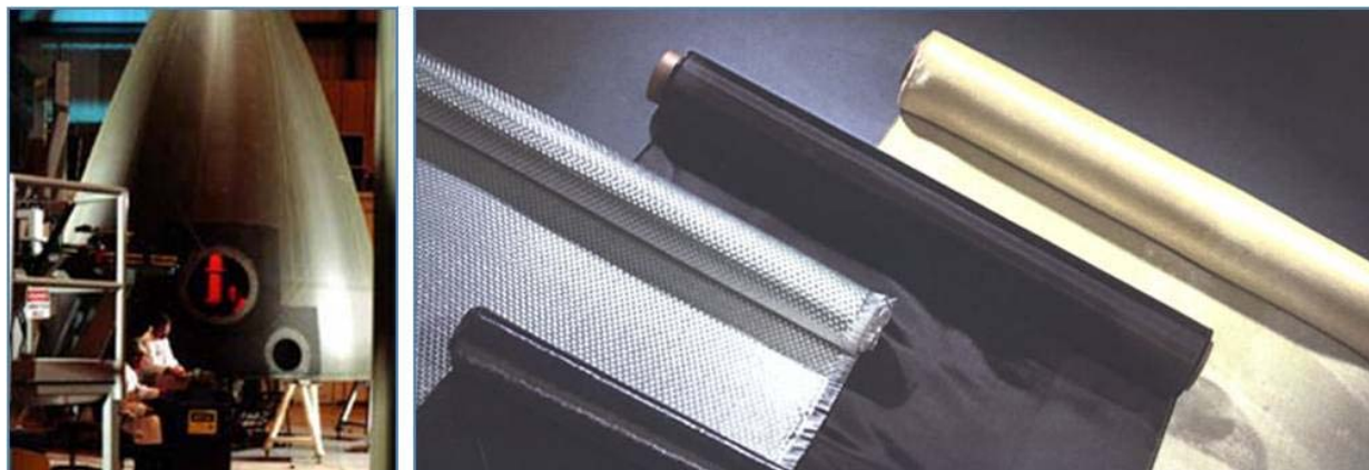
Рисунок 9: Слева: носовой обтекатель ракеты-носителя, изготовленный с использованием передовых технологий пропитки. (АТК) Справа: Материал препрега, используемый в изготовлении легких, высокопрочных конструкций из композитных материалов для аэрокосмической и оборонной техники. (Ibid)
