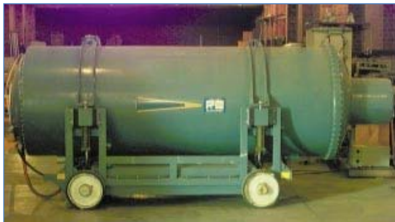
Рис. 15: Импульсный рентген на 2,3 МэВ, используемый при осмотре твердотопливных ракетных двигателей. (Оборудование РКТР, программное обеспечение и приложение к руководству по технологиям, третье издание (май 2005 г.))
