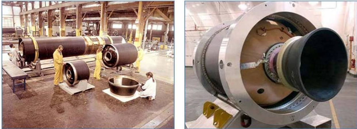
Рис. 6: Слева: Набор сложных корпусов двигателя ракеты, разработанных для широкого диапазона заданий, включая первые, вторые и третьи ступени ракет-носителей. (АТК) Справа: Двигатель ракеты, установленный в корпус ракеты, функционирующий как двигатель третьей ступени ракеты-носителя. (АТК)
