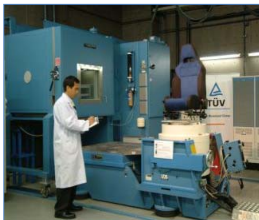
Рис. 12: Конфигурация прибора для проведения испытаний на воздействие вибрации и внешних условий. (TUV Rheinland)
