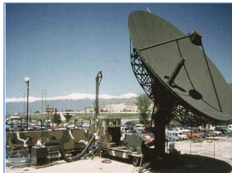
Рис. 53. Большая военная антенна SATCOM, разработанная для крупных командных пунктов и мобильных командных пунктов, подходящая для коммуникаций с БЛА. (General Dynamics)
