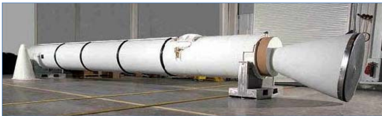
Рис. 8: Двигатель ракеты с большим неподвижным соплом. Двигатель используется на носителе. (АТК)
