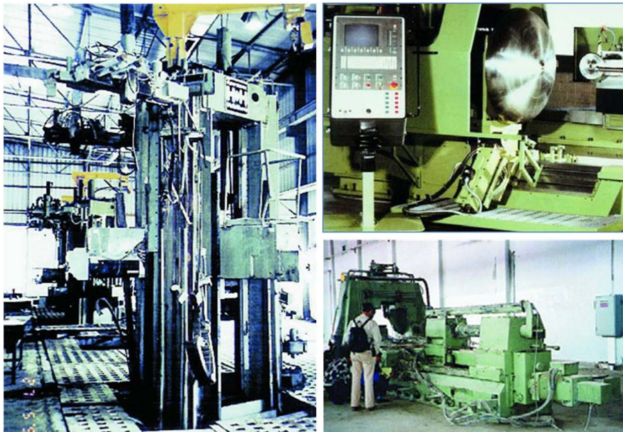
Рис. 18: Вверху справа: Станок холодной раскатки, используемый для изготовления сферообразных наконечников резервуаров ракетного топлива. (Aerojet) Внизу справа: Горизонтальный станок холодной раскатки. («Руководство к приложению двойного назначения Группы ядерных поставщиков», отчет № LA-13131-M (апрель 1996 года) Слева: Вертикальный станок холодной раскатки. (Ibid)
