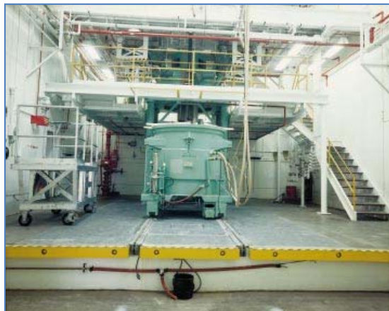
Рисунок 4. 420-галлонная камера смешивания топлива. (АТК)
