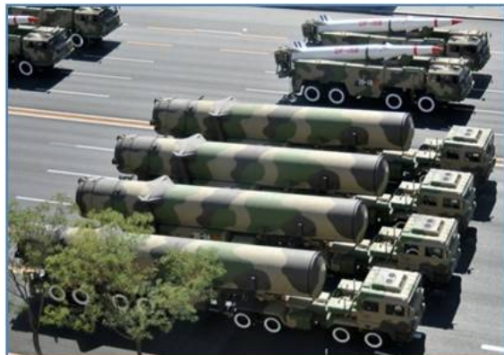
Рис. 3: Сверху: ТПУ с восемью и четырьмя осями, несущие межконтинентальные баллистические ракеты (МБР; передний план), и баллистические ракеты средней дальности (БРСД). (Через китайский Интернет)
