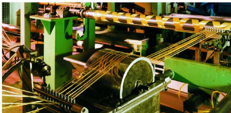
Рисунок 5: Слева: установка для пропитки, производства Composite Materials Group, для изготовления пропитанных материалов с использованием волокон и смол. (Katholieke Universiteit Leuven) Справа: установка добавления смолы к семи линиям пучков. (Hunting Engineering, Ltd.)
