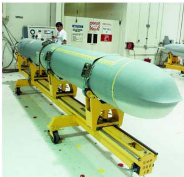
Рисунок 7. Действующая крылатая ракета на контрольно-испытательном стенде; показан ее носовой обтекатель, модифицированный для снижения отражения радиолокационного сигнала и улучшения аэродинамических характеристик. («Руководство РКТР по оборудованию, программному обеспечению и технологиям», третье издание (май 2005 г.))
