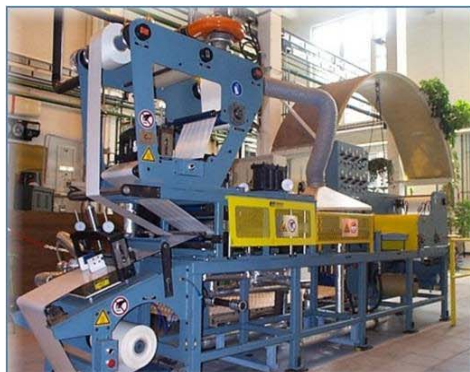
Рисунок 5: Слева: установка для пропитки, производства Composite Materials Group, для изготовления пропитанных материалов с использованием волокон и смол. (Katholieke Universiteit Leuven) Справа: установка добавления смолы к семи линиям пучков. (Hunting Engineering, Ltd.)
