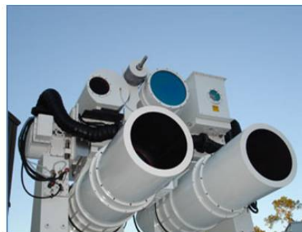
Рис. 18: Электрооптическая лазерная система слежения. (BAE Systems)
