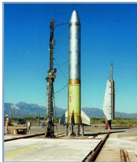
Рис. 3: Минимальная стартовая площадка с пусковой башней и соединениями к законченной ракетной системе. (Руководство по оборудованию, программному обеспечению и технологиям РКРТ с приложениями, третье издание (май 2005 года))
