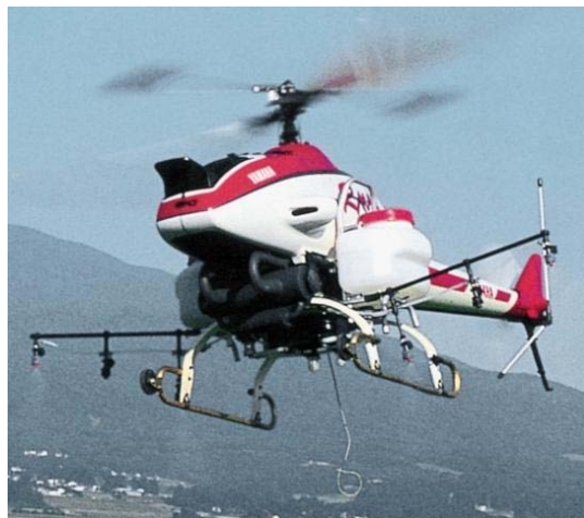
Рис. 5. БЛА с ротационным крылом, собранный с химическими баками и пульверизаторами для применения в сельскохозяйственных целях. (Yamaha)
