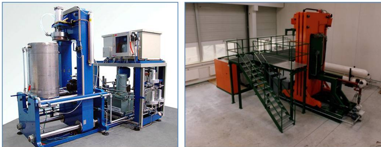
Рисунок 6: Слева: Изостатический пресс лабораторных размеров. (ESPI) Справа: горячий изостатический пресс лабораторных размеров. (Abra Fluid AG)
