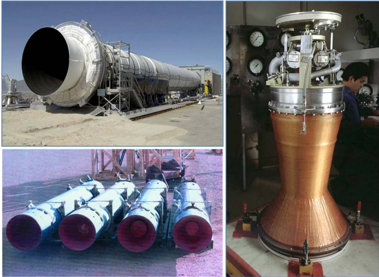
Рисунок 7: Вверху слева: Твёрдотопливный ракетный двигатель для многократного использования в космических кораблях. (АТК) Внизу слева: Твёрдотопливные ракетные двигатели с полным импульсом, близким к более низкому пределу контроля в разделе 2. («Руководство РКТР по оборудованию, программному обеспечению и технологиям», третье издание (май 2005 г.)) Справа: Ракетный двигатель с вытеснительной подачей жидкого топлива. (Воздушно-реактивный)
