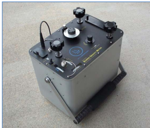
Рис. 9: Этот автоматизированный измеритель силы тяжести является одним из самых точных, прочных и легких измерителей силы тяжести. При нормальных условиях он может дать показания в мГал в течение 30 секунд и имеет коэффициент сдвига менее 0,5 мГал в месяц, когда стабилизирован. (ZLS Corporation)
