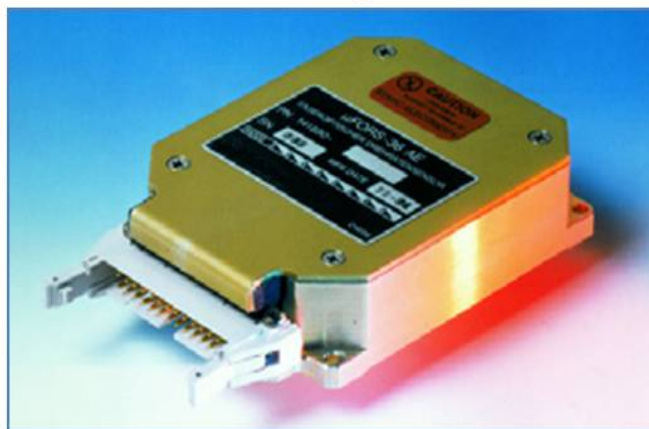
Рис. 12: Вверху слева: три выставленных кольцевых лазерных гироскопа без соответствующей электроники. (Honeywell) Вверху справа: оптоволоконный гироскоп со снятой верхней частью. (Honeywell) Основание: оптоволоконный гироскоп для измерения скорости. Размер: 2 см x 6,5 см x 8 см. (LITEF)
