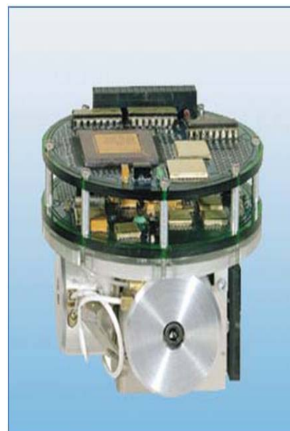
Рис. 15: Инерциальный измерительный блок (IMU) использует инерциальные оптоволоконные гироскопы (FOG) и акселерометры с микрообработкой и используется в космической стабилизации, наведении ракет, БЛА и управлении полетами. (Northrop Grumman)
