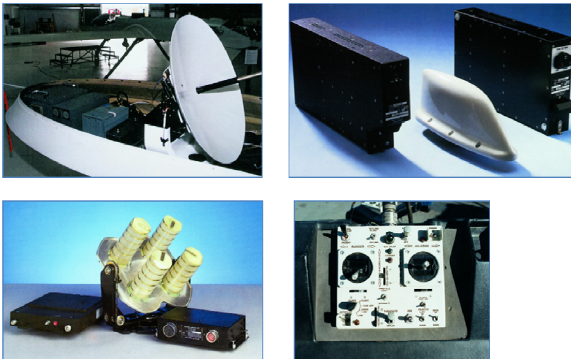
Рис. 18: Верхний левый: Антенна SATCOM, установленная в БЛА (General Atomics Aeronautical). Сверху и справа: Коммерческий спутниковый приемопередатчик с обтекаемой антенной. (Racal Avionics). Снизу справа: Портативный диспетчер полета для БЛА (Оборудование РКТР, программное обеспечение и приложение к руководству по технологиям, третье издание (май 2005 г.)). (АТК) Нижний левый: Коммерческая система с механически управляемой антенной (обтекание не показано). (Racal Avionics)
