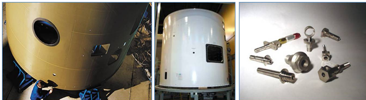
Рис. 10: Слева: Большая центральная секция корпуса из композитного материала предназначена для ракеты-носителя. (АТК) По центру: Типичная секция промежуточной ступени ракеты. (АТК) Справа: Набор взрывчатых болтов, предназначенных для использования в ракетах-носителях и других военных целях. (Accra Tronics Seals Corporation)
