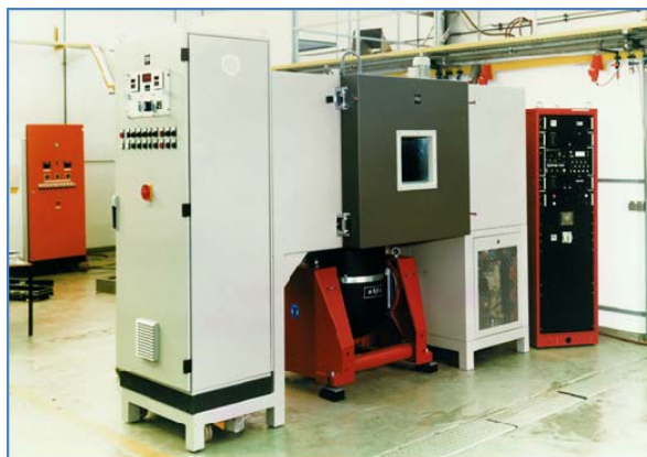
Рис. 13: Управляемая камера с имитацией внешних условий и возможностью вибрации. (RMS Dynamic Test Systems)
