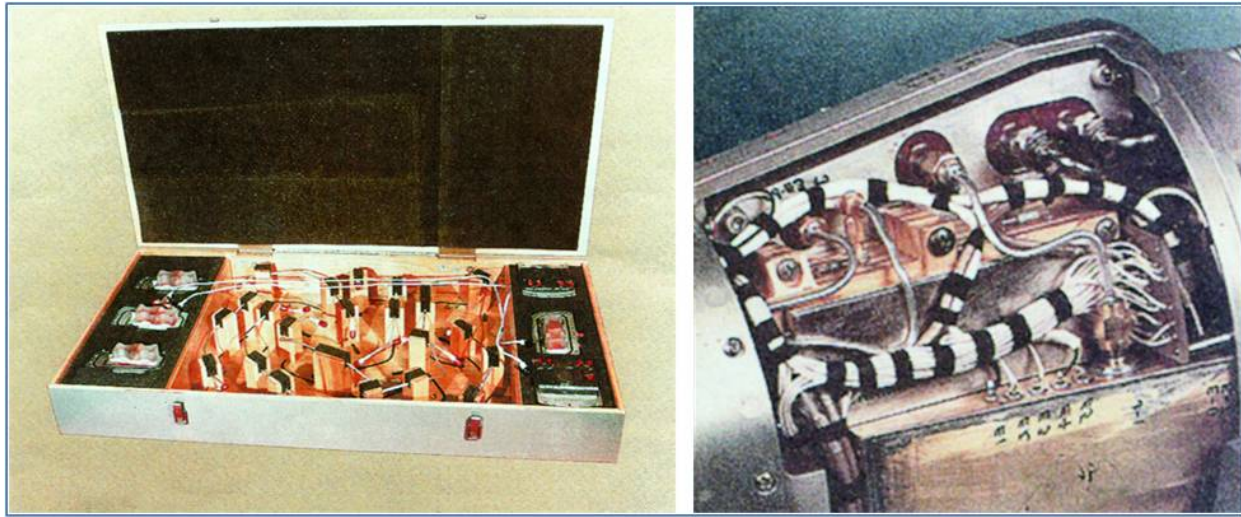
Рисунок 6: Слева: Упакованная для транспортировки радарная антенна возвращаемого аппарата. Справа: Часть радарной электроники возвращаемого аппарата. («Руководство РКТР по оборудованию, программному обеспечению и технологиям», третье издание (май 2005 г.))
