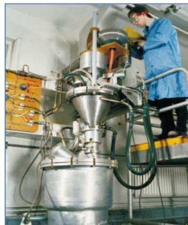
Рисунок 2. Двухосновное смесительное оборудование взвешенного раствора для небольшого двигателя. (British Aerospace Limited)
