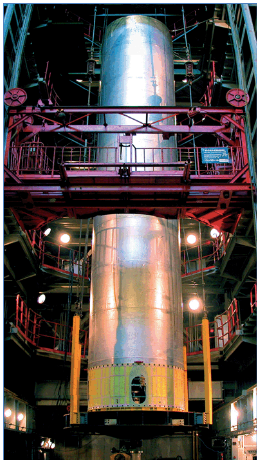
Рис. 3: Ракета-носитель первой ступени в виброиспытательной установке. (Космический центр им. Хруничева)
