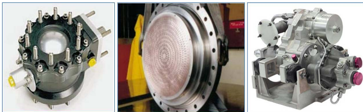
Рис. 12: Слева: Современный распределительный клапан жидкого топлива. (Allied Signal Aerospace) По центру: Пластина инжектора жидкого топлива. (Boeing) Справа: Блок турбокомпрессора для ракеты-носителя. (Hamilton Sundstrand)
