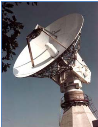
Рис. 12: Система больших телеметрических антенн, разработанная для БЛА и центров летного испытания. (Chelton Antennas)
