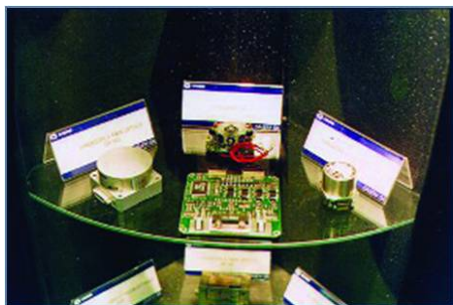
Рис. 9: FOG (слева), RLG (по центру) и акселерометр (справа). («Руководство к приложению РКРТ по оборудованию, программному обеспечению и технологиям», третье издание (май 2005 г.))
