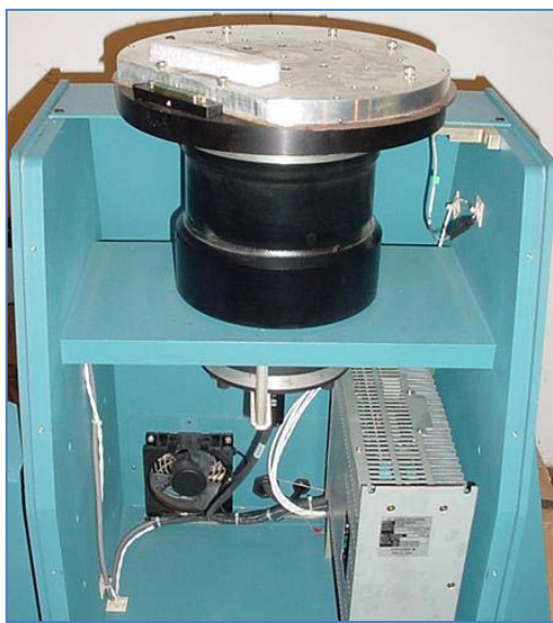
Рис. 21: Типичная таблица скорости, используемая для того, чтобы настроить гироскопы. (Ideal Aerospin, Inc)
