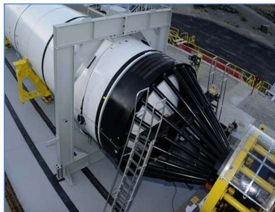
Рис. 8: Система измерения нагрузки стенда для испытания ракетного двигателя на твердом топливе. (АТК)
