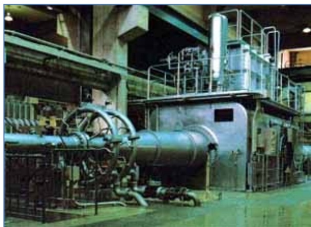
Рис. 5: Гиперзвуковая аэродинамическая труба, способная поток в которой способен достигать скорости 5 Махов для испытания условий полета при запуске летательных аппаратов. (Mitsubishi Heavy Industries, Ltd)
