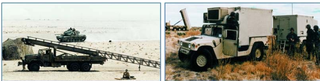
Рис. 8: Слева: Пневматическая пусковая установка БЛА. Справа: Транспортные средства оперативного управления, применяющиеся для запуска ракеты со стационарных или мобильных позиций. (Руководство по оборудованию, программному обеспечению и технологиям РКТР с приложениями, третье издание (май 2005 года))
