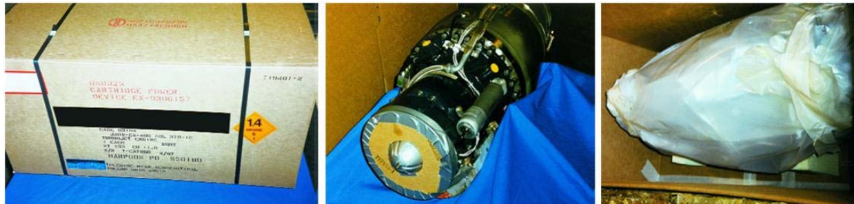
Рис. 2: Слева: Ящик для доставки турбореактивного двигателя с предупреждающими ярлыками, необходимыми в связи с наличием пускового картриджа. (Teledyne Ryan Aeronautical) По центру: Небольшой турбовентиляторный двигатель в пластиковой упаковке, внутри ящика для морских перевозок. (Teledyne Ryan Aeronautical) Справа: Небольшой турбореактивный двигатель, подготовленный к отгрузке. (Teledyne Ryan Aeronautical)
