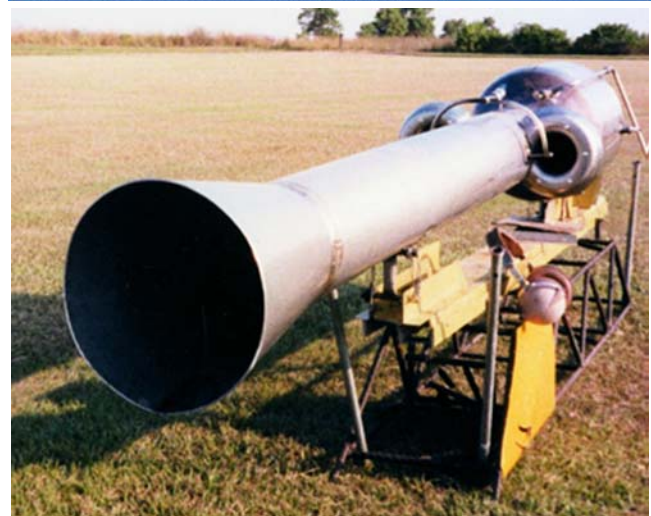
Рис. 3: Сверху: Большой прямоточный реактивный двигатель. (March Field Air Museum) Посередине: Гиперзвуковой прямоточный воздушно-реактивный двигатель завершает испытание в аэродинамической трубе при значении числа 5 Маха. (Pratt & Whitney / NASA) Внизу: Современный пульсирующий реактивный двигатель с воздухозабором, расположенным в хвостовой части. (Thermojet)
