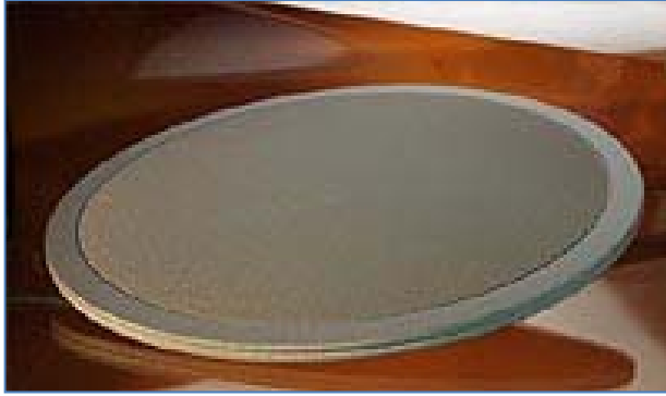
Рисунок 13: Покрытие из карбида кремния находит широкое применение в космической и аэрокосмической отраслях, включая защиту графитового материала от окисления. (Schunk Group)
