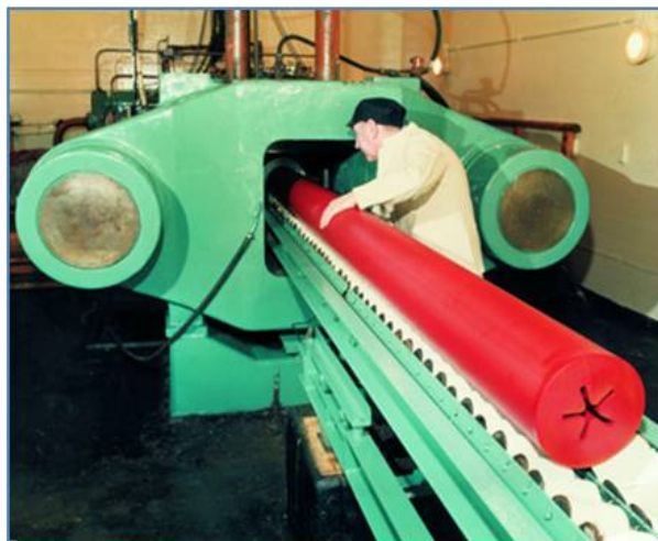
Рисунок 5. Просвечивание готового двигателя рентгеновским излучением для проверки однородности твердотопливного заряда, полного прилегания его к корпусу и отсутствия трещин. (АТК)
