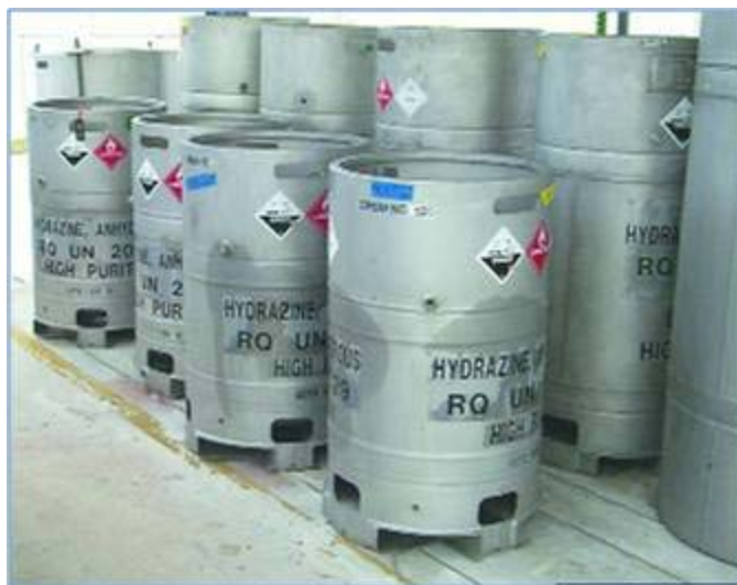
Рисунок 9. 34-галлонные контейнеры для транспортировки обезвоженного гидразина, сделанные из нержавеющей стали 300-й серии. («Приложение к руководству РКТР по оборудованию, программному обеспечению и технологиям», Третье издание (май 2005))
