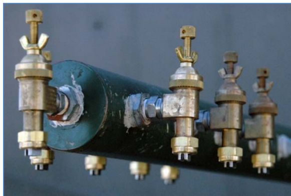
Рис. 4. Модульная воздушная система орошения, применяемая для распыления пестицидов, может использовать комплектацию, называемую «сверхнизкий объем» и специализироваться на штангах с распыляющими насадками, такими как показаны здесь, чтобы распылять половину унции химиката на один акр. (ВВС США)
