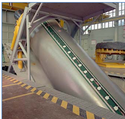
Рисунок 3. Твердое топливо в жидком виде льется в корпус ракеты и заливается в необходимую форму. Устройство заливки перемещается гидравлическим держателем для удаления пузырьков или других дефектов. (АТК)
