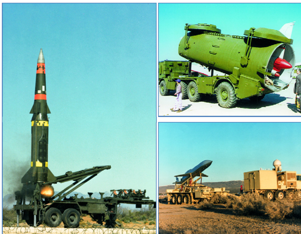
Рис. 7: Слева: пусковая установка, отделенная от тягача. (Оборудование РКТР, руководство приложения «Программное обеспечение и технология», третий выпуск (май 2005)) Сверху справа: пусковая установка транспортера для больших крылатых ракет категории II. (Оборудование РКТР, руководство приложения «Программное обеспечение и технология», третий выпуск (май 2005)) Снизу справа: Пусковая установка для БЛА с реактивным запуском и его фургон оперативного управления. (Teledyne Ryan Aeronautical)
