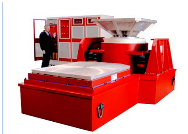
Рис. 4: Пример толкателя и стола скольжения. (Kingdom Pty Ltd)
