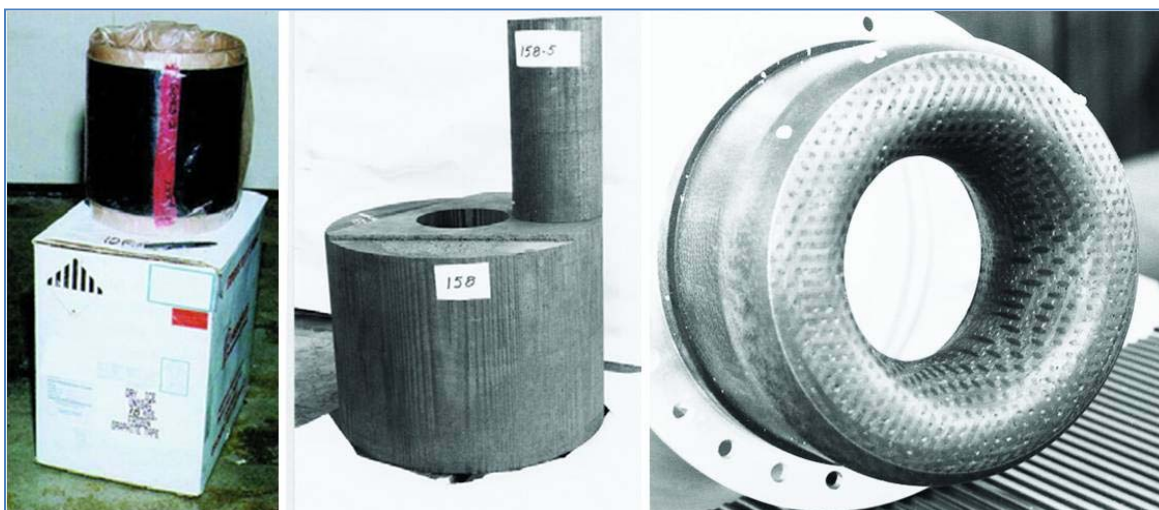
Рисунок 10 Слева: Специальный картонный контейнер для обкладывания катушки с лентой препрега углеродистого волокна сухим льдом во время транспортировки. Сухой лед обычно содержится в полиэтиленовом пакете, уложенном вокруг катушки. («Приложение двойного назначения к руководству для группы ядерных поставщиков», «Отчет № LA-13131-M» (апрель 1996 г.)) Середина: кусок углерод-углеродного материала, готовый для машинной обработки и отправки в сопло ракеты. Большой цилиндрический блок составляет приблизительно 70 см в диаметре. (Ibid) Справа: Углерод-углеродное горло сопла ракеты с видимым узором, созданным нижележащими волокнами ткани. (Ibid)
