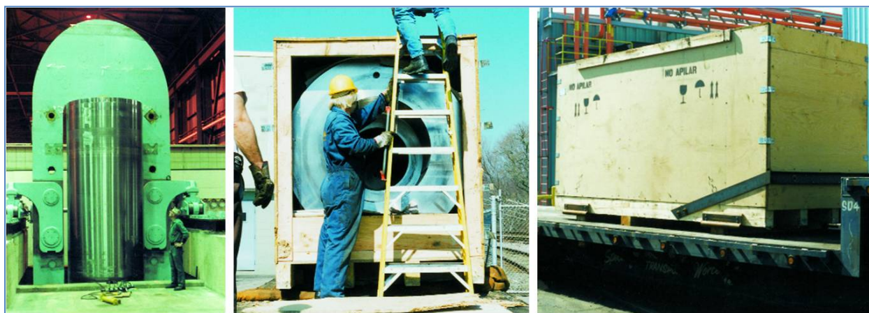
Рисунок 7: Слева: вид большого изостатического прессы сбоку. (Engineered Pressure Systems, Inc.) Центр и справа: два различных вида альтернативного транспортного контейнера для изостатического прессы. (Engineered Pressure Systems, Inc.)
