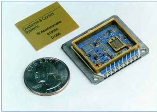
Рис. 14: Акселерометр с интегральной схемой, допускаемый для использования в условиях свыше 100 g. («Руководство к приложению РКРТ по оборудованию, программному обеспечению и технологиям», третье издание (май 2005 г.))
