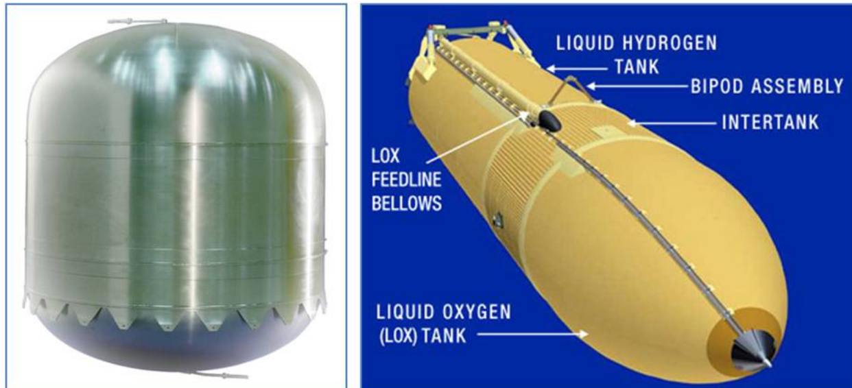
Рис. 16 Слева: Типичный резервуар жидкого топлива разработан для ряда применений в аэрокосмической отрасли. (EADS) Справа: Диаграмма внешнего резервуара, используемого в двигателе космической ракеты-носителя, показывающая отдельные баки для окислителя и топлива. (НАСА)
