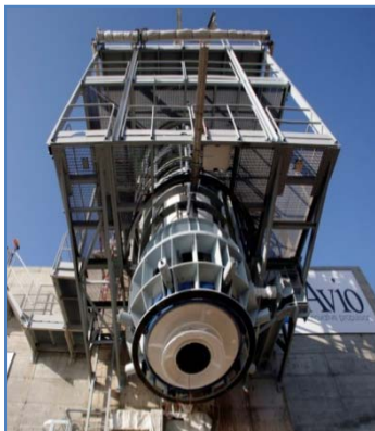
Рис. 10: Ракетный двигатель на твердом топливе, расположенный на испытательном стенде. (Avio SpA)
