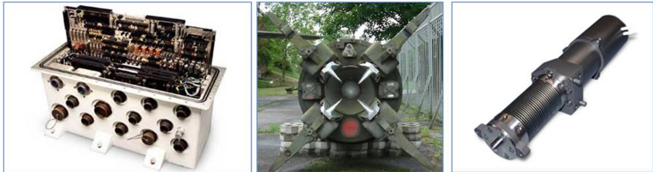
Рисунок 11: Слева: Электронный блок управления вектором тяги для использования в больших ракетах-носителях. (Moog, Inc.) В центре: Четыре реактивных лопасти, установленные в задней части баллистической ракеты. (Российские военные силы) Справа: Линейный силовой привод тонкого позиционирования, разработанный для применения в аэрокосмической отрасли. (Moog, Inc.)
