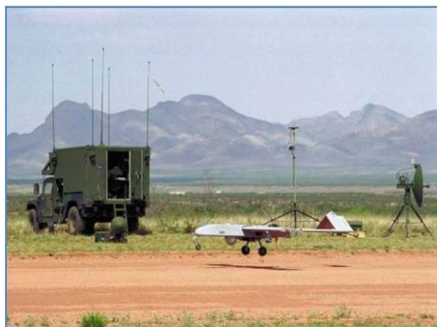
Рис. 6: Справа: Транспортное средство наземного управления (транспортное средство, слева), способное управлять серией систем БЛА. (AAI Corporation)
