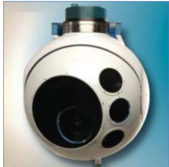
Рис. 2: Пассивный датчик обнаружения является высокоэффективной инфракрасной системой БЛА, которая может обслуживать до шести датчиков. (Northrop Grumman)
