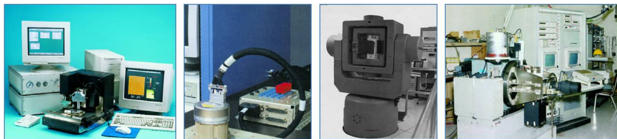
Рис. 23: Слева: система профилометра используется для того, чтобы измерить зеркала. (Цифровые приборы) посередине слева: другой портативный тестер IMU, подключенный к миниатюрному IMU. (Руководство и системы управления Litton) справа посередине: платформа с тремя осями для того, чтобы проверить IMU или гироскопы. («Руководство к приложению РКРТ по оборудованию, программному обеспечению и технологиям», третье издание (май 2005 г.)) Справа: делительная головка с температурной камерой контроля для того, чтобы проверить акселерометр в камере. (Litton Guidance & Control Systems)
