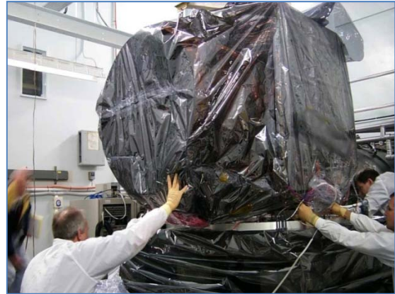
Рис. 1. Испытание на вибрацию системы лазерного высотомера. (NASA)
