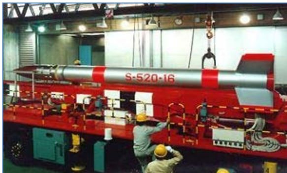
Рис. 1: Большая исследовательская ракета категории II, способная доставлять полезную нагрузку 250 кг на расстояние 400 км. Двигатель ракеты на твердом топливе заключен в стальной листовой кожух. Двигатель окружают четыре «отовых» хвостовых стабилизатора с передними кромками из титанового сплава. (JAXA)
