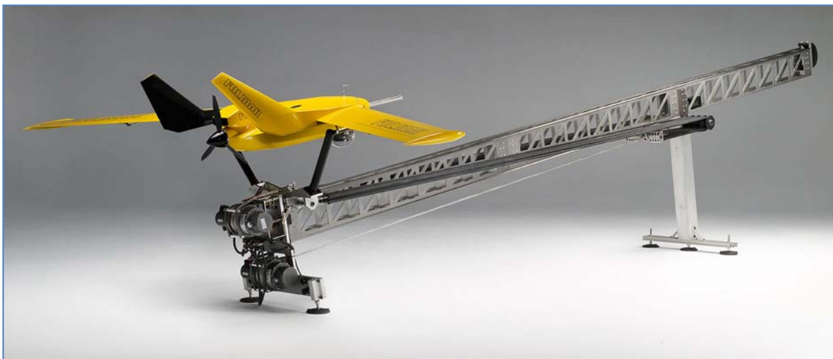
Рис. 3: БЛА средней дальности полета. Несмотря на его небольшой размер, этот эластичный БЛА, запускаемый с катапульты, способен переносить 1 кг «полезной нагрузки» (ИК и цифровые камеры) на дальность до 400 км. (Аэровизайон Вехикулос Аереос, SL)
