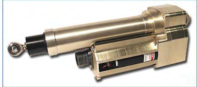
Imagen 96: Un actuador lineal utilizado para colocar el paso de las paletas del rotor en un vehículo aéreo no tripulado con rotor de inclinación y diseñado para operar en condiciones ambientales y de resistencia extremas. (Moog, Inc)
