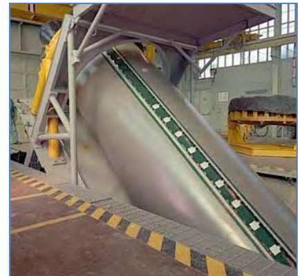
Imagen 49: El propulsante sólido en forma líquida se vierte en las carcasas de los cohetes y se moldea en la forma requerida. El bastidor se mueve mediante un soporte hidráulico para eliminar burbujas u otros defectos. (JAXA)
