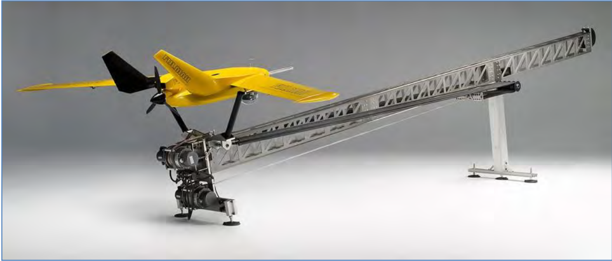
Imagen 164: Un UAV de resistencia de rango medio. A pesar de su pequeño tamaño, este UAV elástico lanzado en catapulta es capaz de transportar una carga útil de 1 kg (IR y cámaras digitales) a un alcance de 400 km. (Aerovision Vehículos Aéreos, SL)
