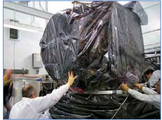
Imagen 132: Prueba de vibración de un sistema de altímetro láser. (JAXA)
