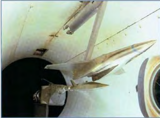
Imagen 138: Objetos de prueba en la sección de prueba de un túnel de viento hipersónico. (MTCR Equipment, Software and Technology Annex Handbook, Third Edition (May 2005))
