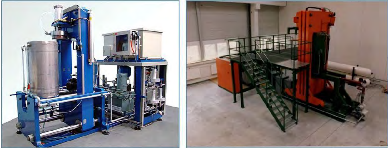
Imagen 65: Izquierda: Una prensa isostática de tamaño de laboratorio. (ESPI) Derecha: Una prensa isostática caliente del tamaño de un laboratorio. (Abra Fluid AG)
