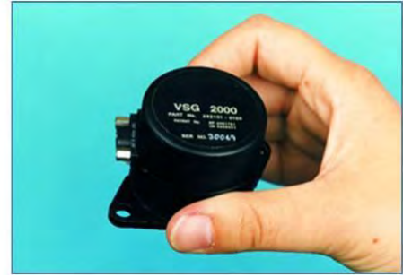
Imagen 81: Una estructura vibratoria giroscópica. (British Aerospace Ltd.)
