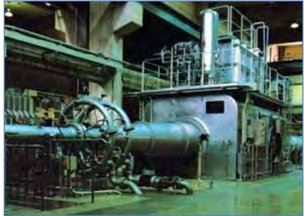
Imagen 136: Un túnel de viento hipersónico capaz de igualar Mach 5 para probar las condiciones de vuelo de los vehículos de lanzamiento. (Mitsubishi Heavy Industries, Ltd)
