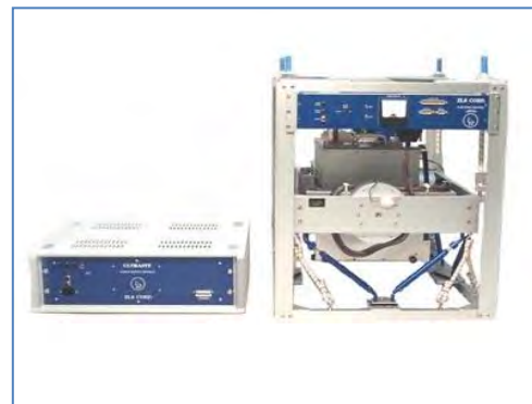
Imagen 116: un medidor dinámico. El sistema de control digital completo del medidor mejora la precisión general del sistema al eliminar la ganancia y las desviaciones de compensación inherentes a la electrónica analógica. (Corporación ZLS)
