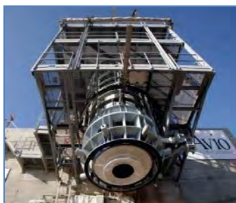
Imagen 140: Un motor cohete propulsante sólido en un banco de pruebas. (Avio SpA)
