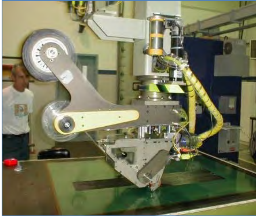
Imagen 62: Un cabezal de máquina para el tendido de cintas automatizado. (Dinámica automatizada)
