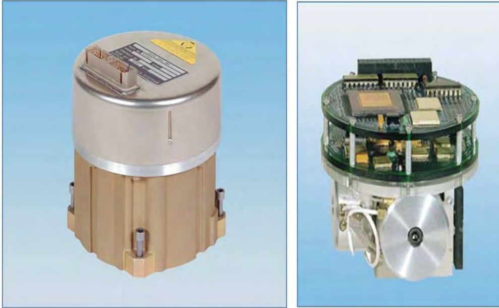
Imagen 87: Una unidad de medición inercial (IMU) utiliza giroscopios de fibra óptica inercial (FOG) y acelerómetros micro-mecanizados y se utiliza en estabilización de espacios, guía de misiles, guía de UAV y control de vuelo. (Northrop Grumman)
