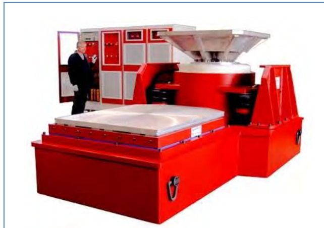
Imagen 135: Un ejemplo de hélice con mesa deslizante. (Kingdom Pty Ltd)
