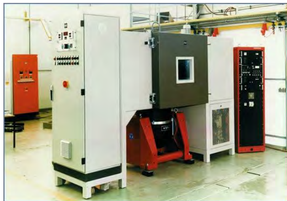
Imagen 144: Una cámara ambiental controlada con capacidad de vibración. (Sistemas de prueba dinámica RMS)
