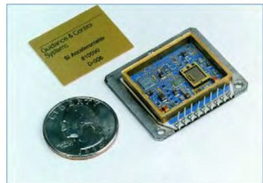
Imagen 86: Un acelerómetro de circuito integrado de más de 100 g. (MTCR Equipment, Software and Technology Annex Handbook, Third Edition (May 2005))
