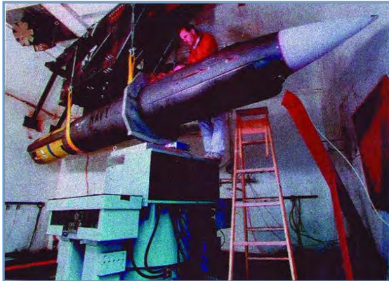
Imagen 133: Un propulsante preparado para la vibración: prueba un misil. (Unholtz-Dickie)
