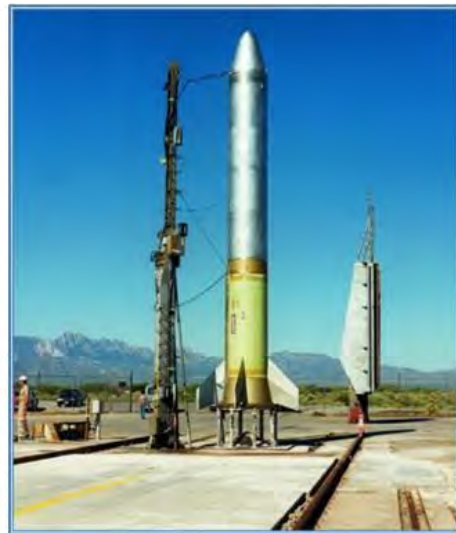
Imagen 108: Plataforma de lanzamiento mínima con un pórtico y conexiones a un sistema completo de cohetes. (MTCR Equipment, Software and Technology Annex Handbook, Third Edition (May 2005))
