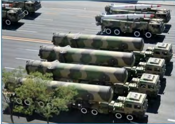
Imagen 111: Arriba: Ocho ejes MEL que llevan misiles balísticos intercontinentales (ICBM; primer plano) y cuatro ejes TEL que llevan misiles balísticos de rango intermedio (IRBM). (A través de Internet chino)
