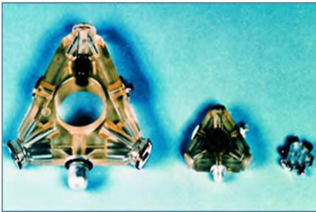
Imagen 83: Un FOG (izquierda), un RLG (centro) y un acelerómetro (derecha). (MTCR Equipment, Software and Technology Annex Handbook, Third Edition (May 2005))
