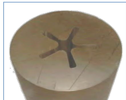
Imagen 56: Una muestra de propulsante de motor de cohete de doble base. (Bayern-Chemie GmbH)
