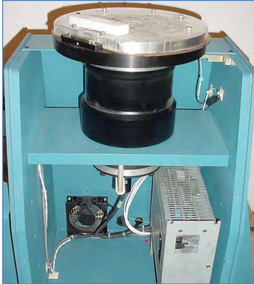
Imagen 93: Una tabla de tasas típica utilizada para sintonizar giroscopios. (Ideal Aeromsmith, Inc)
