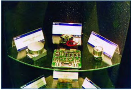
Imagen 83: Un FOG (izquierda), un RLG (centro) y un acelerómetro (derecha). (MTCR Equipment, Software and Technology Annex Handbook, Third Edition (May 2005))
