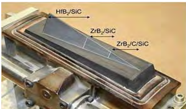
Imagen 73: Una capa de UHTC compuesta de tres secciones diferentes con diferentes composiciones de UHTC (Manual de compuestos de cerámica)
