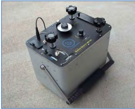
Imagen 115: Este medidor de gravedad automatizado es uno de los medidores de gravedad más precisos, resistentes y livianos. En condiciones normales, puede nivelarse para lecturas de mGal en 30 segundos y tiene una velocidad de deriva de menos de 0,5 mGals por mes. (Corporación ZLS)
