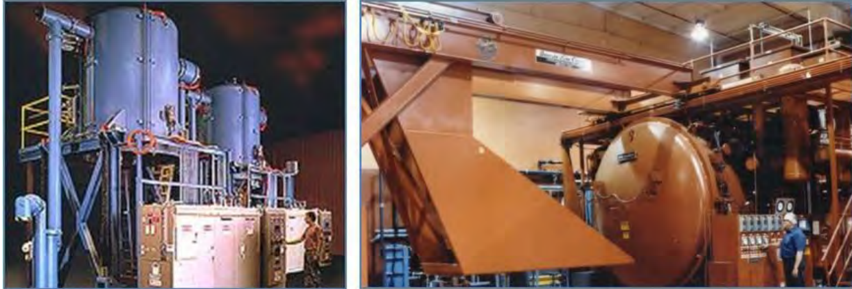
Imagen 67: Izquierda: Un horno de CVD personalizado a gran escala que calienta inductivamente el grafito a temperaturas en el rango de 2800 °C. (CVI) Derecha: Un gran horno de CVD. (Seco Warick)
