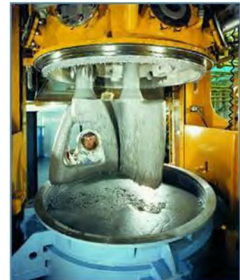
Imagen 53: propulsante sólido mezclado en una mezcladora planetaria vertical de 600 galones. (Thiokol Corp.)
