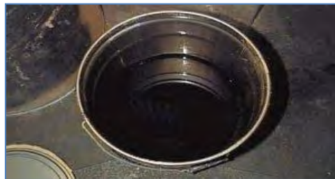
Imagen 59: Un tambor de envío de ácido polibutadieno-ácido acrílico-acrilonitrilo (PBAN). (The Charles Stark Draper Laboratories)
