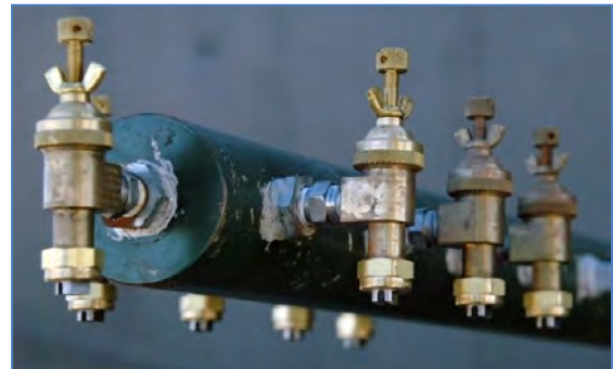
Imagen 165: Un sistema modular de rociado aéreo, utilizado para la aplicación de pesticidas, puede usar una configuración llamada toberas de pulverización especializadas de volumen ultra bajo como las que se muestran aquí para extender la mitad a una onza de químico sobre un acre. (Fuerza aérea de los EE. UU.)
