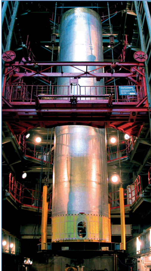
Imagen 134: Un refuerzo principal de primera etapa en una plataforma de prueba de vibraciones. (Krunichev Space Center)
