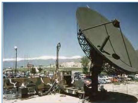
Imagen 119: Una gran antena militar SATCOM diseñada para puestos de comando principales y puestos de comando móviles, y adecuada para comunicaciones con UAV. (General Dynamics)
