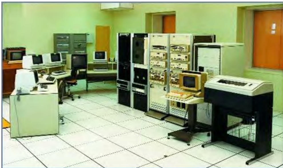
Imagen 121: Equipo representativo de recepción y procesamiento de telemetría de estación terrestre. (In-Snec)
