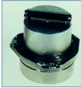
Imagen 82: Un giroscopio sintonizado dinámicamente (DTG). (The Charles Stark Draper Laboratories, Inc.)
