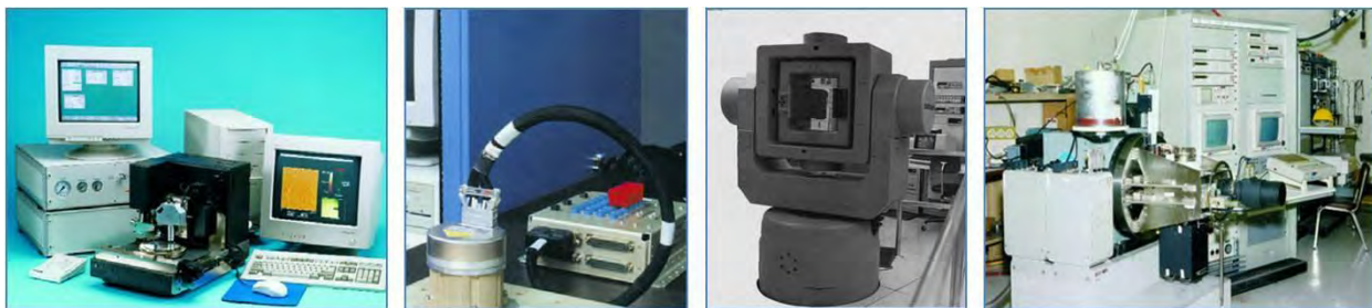
Imagen 95: Izquierda: un sistema de perfilómetro utilizado para medir espejos. (Instrumentos digitales) Centro a la izquierda: es otro probador de IMU portátil conectado a una IMU en miniatura. (Sistemas de guiado y control de Litton) Centro a la derecha: es una tabla de tres ejes para probar IMU o giroscopios.
