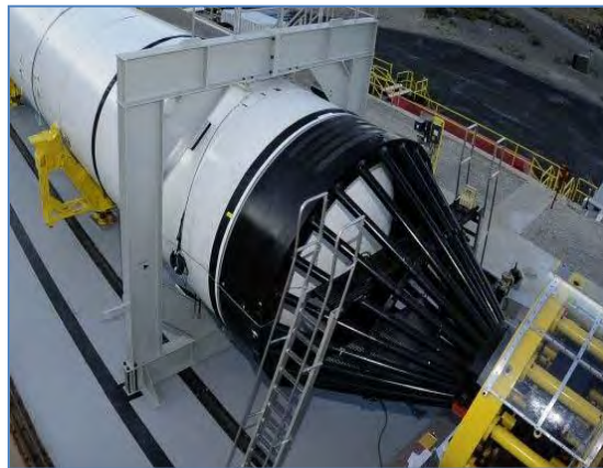
Imagen 139: El sistema de medición de carga en el banco de pruebas de un motor de cohete de propulsante sólido. (JAXA)
