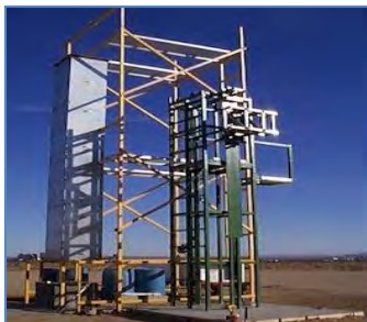
Imagen 141: Un banco de pruebas vertical diseñado para probar motores de cohetes de propulsión líquida. (Interorbital Systems)
