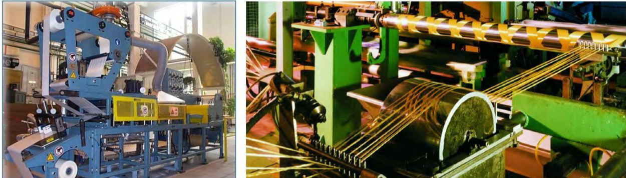
Imagen 64: Izquierda: Una máquina de preimpregnación construida por el Grupo de materiales compuestos para la producción de materiales de preimpregnación con fibras y resinas. (Katholieke Universiteit Leuven) Derecha: Una máquina que agrega resina a siete líneas de cables. (Hunting Engineering, Ltd.)
