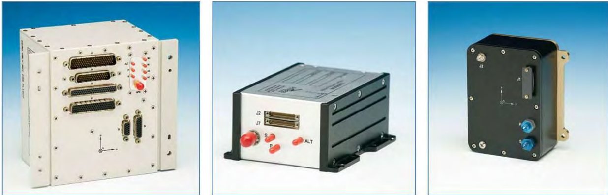
Imagen 75: Una selección de sistemas de navegación inercial (INS) diseñados para aplicaciones de UAV. Desde la izquierda: un sistema de piloto automático y gestión de misiones para UAV y otras aplicaciones militares; un sistema INS/GPS completamente integrado; y un sistema que ha integrado giroscopios de estado sólido, acelerómetros, magnetómetros y receptores de GPS. (Rockwell Collins)
