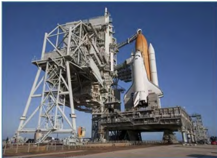
Imagen 109: Una plataforma de lanzamiento con un transbordador espacial en una plataforma de inicio móvil antes del lanzamiento. (JAXA)
