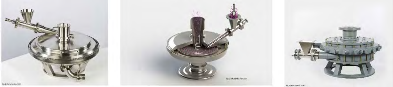
Imagen 54: Ejemplos de varios molinos de energía fluida. (The Jet Pulverizer Company)
