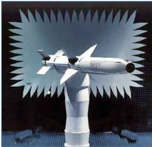
Imagen 156: Un misil objetivo en el rango compacto de medición RCS de la Cámara Anecoica Bistática (BAC). (U.S. Navy)
