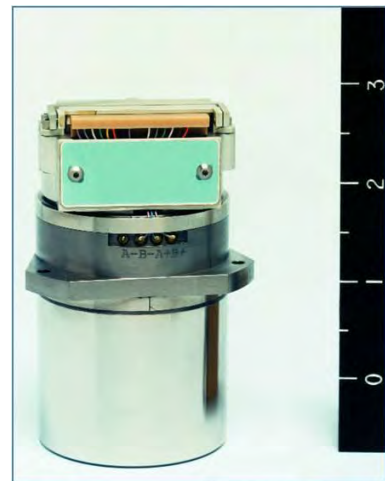
Imagen 78: Un acelerómetro giroscópico de integración pendular (PIGA) junto a una escala en pulgadas. (The Charles Stark Draper Laboratories, Inc.)
