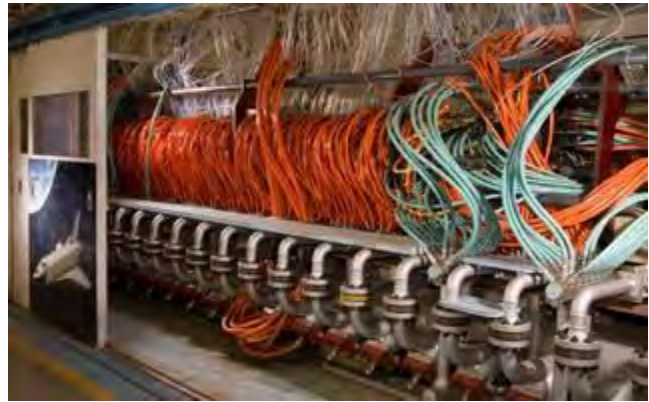
Imagen 147: Instalación de calentamiento por interacción (60 MW) de chorro de arco. (National Aeronautics and Space Administration (NASA))
