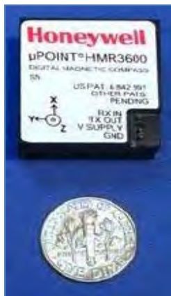
Imagen 92: Este módulo de brújula magnética giroestabilizado utiliza sensores de rumbo magnéticos de tres ejes. Honeywell
