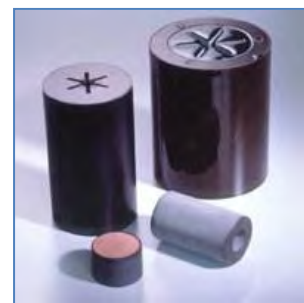
Imagen 55: Propulsores compuestos fabricados para su uso en motores de cohetes. (Industrias Químicas Daicel, Ltd)
