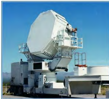
Imagen 124: Un radar móvil de rastreo de misiles de matriz en fase. (MTCR Equipment, Software and Technology Annex Handbook, Third Edition (May 2005))
