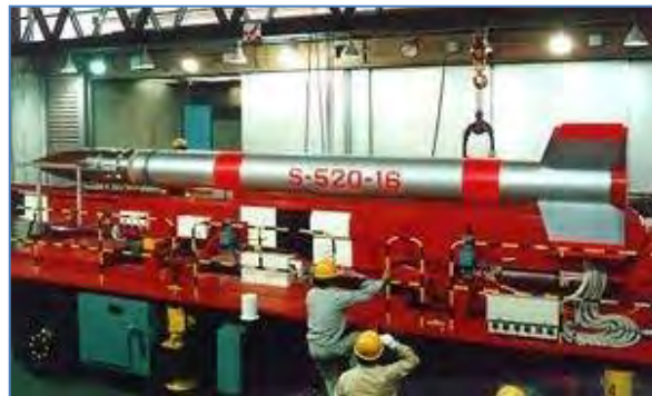
Imagen 162: Un gran cohete sonda de Categoría II, capaz de entregar una carga útil de 250 kg a un alcance de 400 km. El sólido motor propulsante del cohete, con carcasa de acero, está rodeado por cuatro aletas traseras de panel con bordes de ataque de aleación de titanio. (JAXA)
