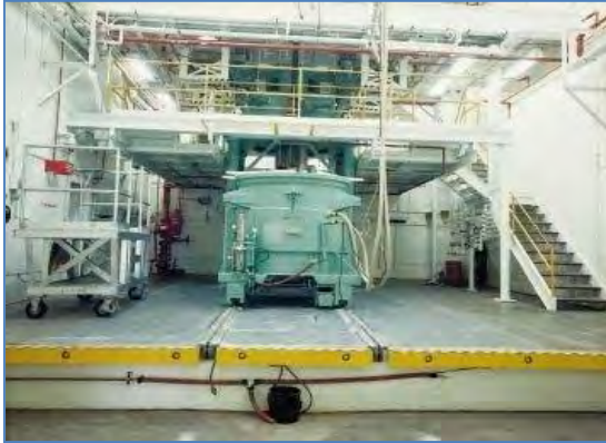
Imagen 52: Un recipiente para mezclar propulsante de 420 galones. (JAXA)
