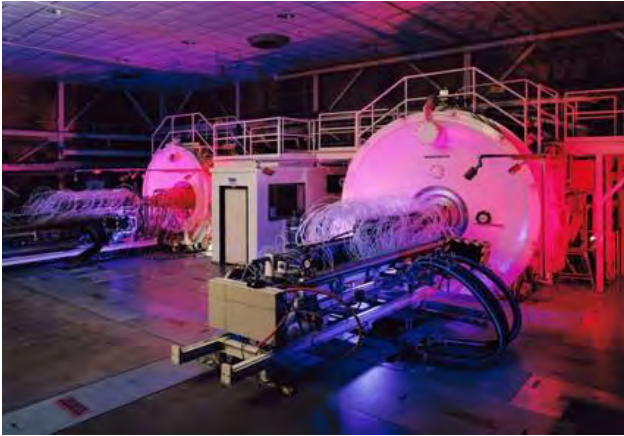
Imagen 148: Imagen del interior del Johnson Space Center (JSC) Materiales de reentrada atmosférica e Instalación de evaluación de estructuras (Arc-Jet) (NASA)
