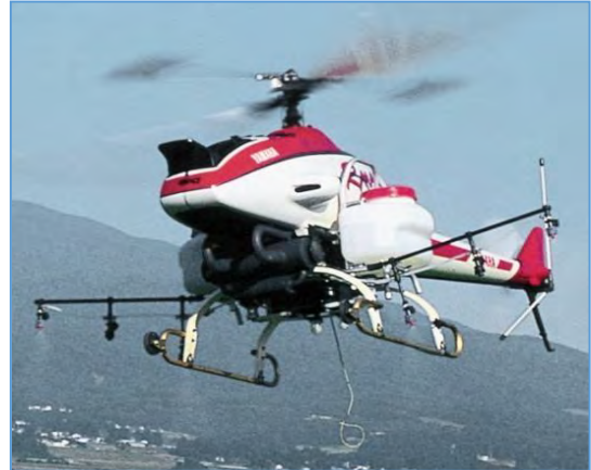
Imagen 166: Un UAV de ala giratoria diseñado con tanques químicos y barras de pulverización para fines agrícolas. Yamaha
