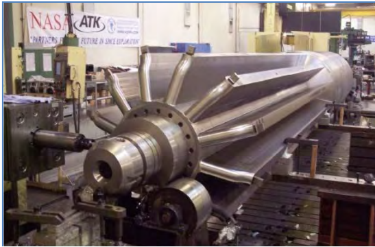
Imagen 48: Un mandril de fundición
