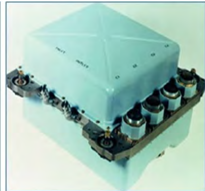
Imagen 129: Un conjunto electrónico resistente a la radiación con refrigeración líquida. (The Charles Stark Draper Laboratory, Inc.)
