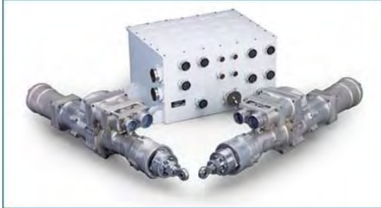
Imagen 97: Un subsistema de control de vector de empuje electromecánico, con actuador lineal y caja electrónica asociada, utilizada en cohetes, incluidos vehículos de lanzamiento espacial. (Moog, Inc)
