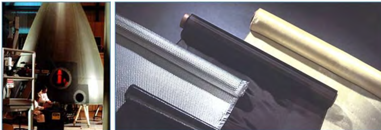
Imagen 68: Izquierda: Un cono de ojiva para un vehículo de lanzamiento espacial fabricado con técnicas avanzadas de preimpregnación. (ATK) Derecha: Material preimpregnado utilizado en la fabricación de estructuras aeroespaciales y de defensa compuestas livianas y de alta resistencia. (Ibidem)
