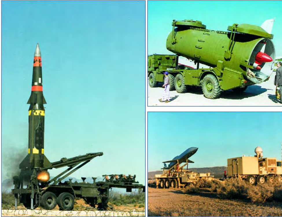
Imagen 113: Izquierda: un lanzador erector separado de su motor principal. Anexo de Equipo, programas informáticos y tecnología del MTCR Handbook, Third Edition (May 2005)). Arriba a la derecha: un lanzador de transportador para un gran misil de crucero Categoría II. (Manual de equipo, programas informáticos y tecnología del MTCR, tercera edición (mayo de 2005)) Abajo a la derecha: Lanzador erector para un UAV asistido por cohete y su van asociada de comando y control. (Teledyne Ryan Aeronáutica)
