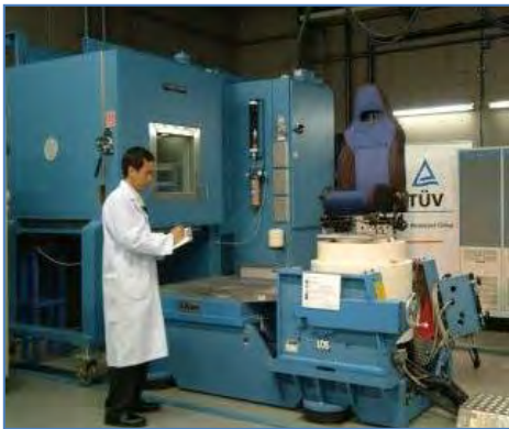
Imagen 143: Una configuración del aparato de prueba de vibración y ambiental. (TUV Rheinland)
