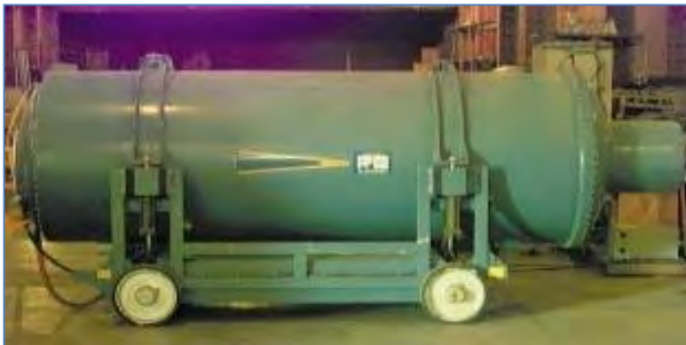
Imagen 146: Una unidad de rayos X flash de 2.3MeV utilizada para inspeccionar motores de cohetes de propulsante sólido. (MTCR Equipment, Software and Technology Annex Handbook, Third Edition (May 2005))
