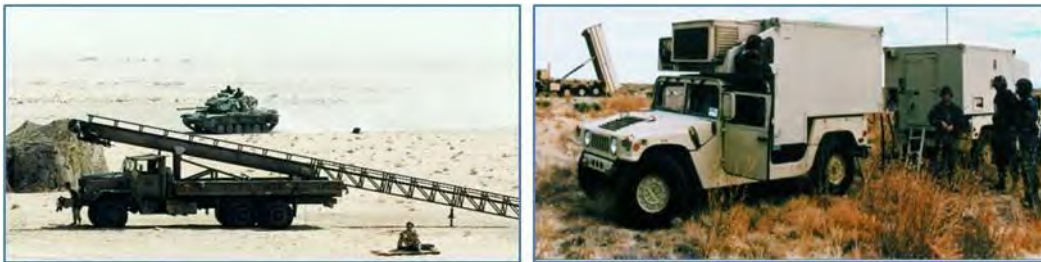
Imagen 114: Un lanzador neumático de UAV. Derecha: Vehículos de comando y control adecuados para lanzar misiles desde ubicaciones fijas o móviles. (MTCR Equipment, Software and Technology Annex Handbook, Third Edition (May 2005))
