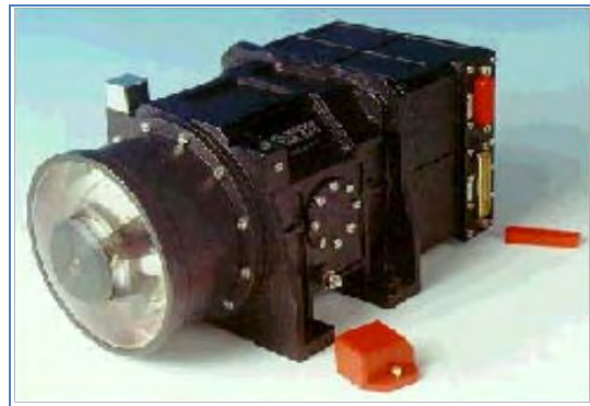
Imagen 76: Una brújula giroscópica de alta resolución. (Litton Alenia Difesa)
