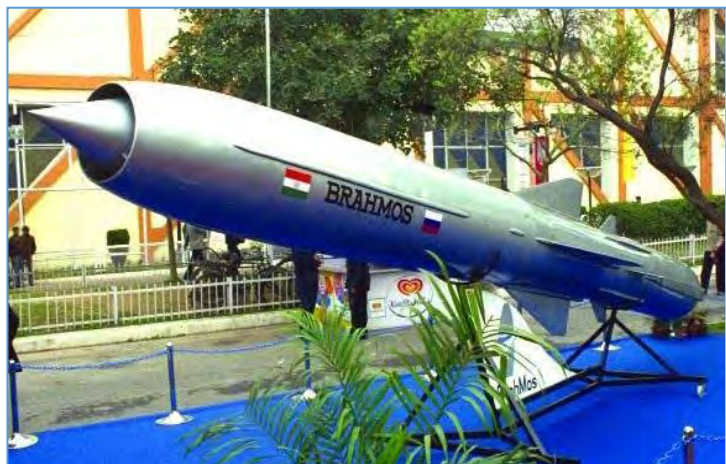
Imagen 163: Un misil de crucero antibuque de Categoría II. (Manual de equipo, programas informáticos y tecnología del MTCR, tercera edición (mayo de 2005))
