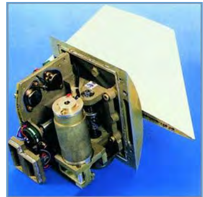
Imagen 98: Un actuador de control de vuelo electromecánico para una aleta trasera de un pequeño misil. (Daimler Benz Aerospace)
