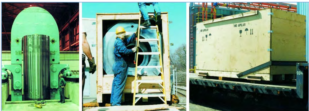
Imagen 66: Izquierda: Vista lateral de una gran prensa isostática. (Engineered Pressure Systems, Inc.) Centro y derecha: Dos vistas diferentes de una caja de envío alternativa para una prensa isostática. (Engineered Pressure Systems, Inc.)
