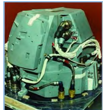
Imagen 74: El cuerpo principal del sistema integrado de instrumentos de vuelo de un misil de crucero. (Sistemas de guía y control de Litton)
