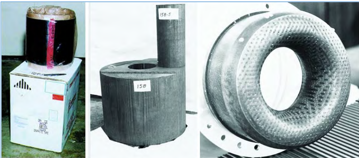
Imagen 69 Izquierda: Contenedor de cartón especial para guardar el hielo seco en un carrete de cinta preimpregnada de fibra de carbono durante el envío. El hielo seco normalmente está contenido en una bolsa de plástico empacada alrededor del carrete. (Manual para el anexo de doble uso del Grupo de Proveedores Nucleares, Informe n.º LA-13131-M (abril de 1996) Izquierda: Un bloque de material de carbono-carbono listo para ser mecanizado en una tobera de cohete. El bloque cilíndrico más grande tiene aproximadamente 70 cm de diámetro. (Ibid) Derecha: Una garganta de tobera de cohete de carbono-carbono que muestra el patrón de tejido de las fibras subyacentes. (Ibidem)
